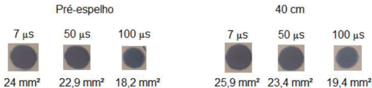
Figura 46 – Diâmetro dos spots para \lambda = 532 nm
