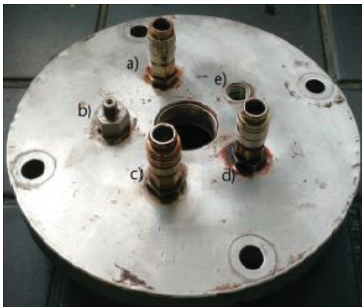
FIGURA 9 - ENTRADAS E SAÍDAS NO REATOR.
