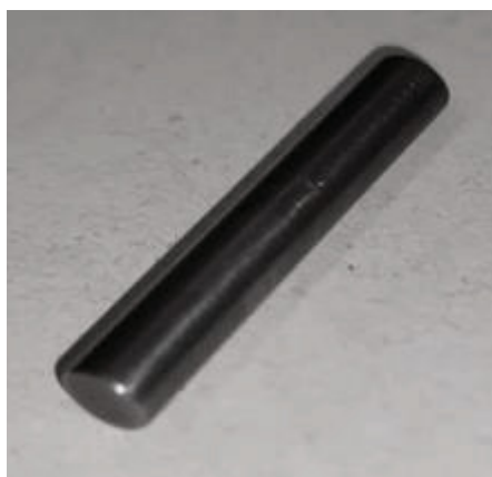
FIGURA 29 – FILME SOBRE A SUPERFÍCIE DO ELETRODO DE TRABALHO (ASTM A335 P5) APÓS TESTES COM NAT8,0 mg KOH g -1 .
