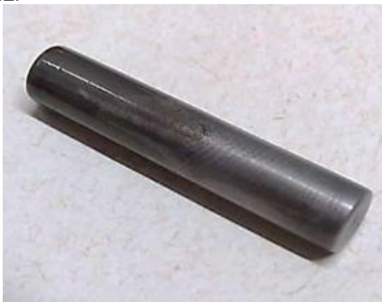
FIGURA 32 - ELETRODO DE TRABALHO DE AÇO ASTM A335 P5 APÓS EXPERIMENTO EM CONDIÇÃO DE NAT 28,0 mg KOH g -1 RECOBERTO POR UM FILME SOBRE SUA SUPERFÍCIE.
