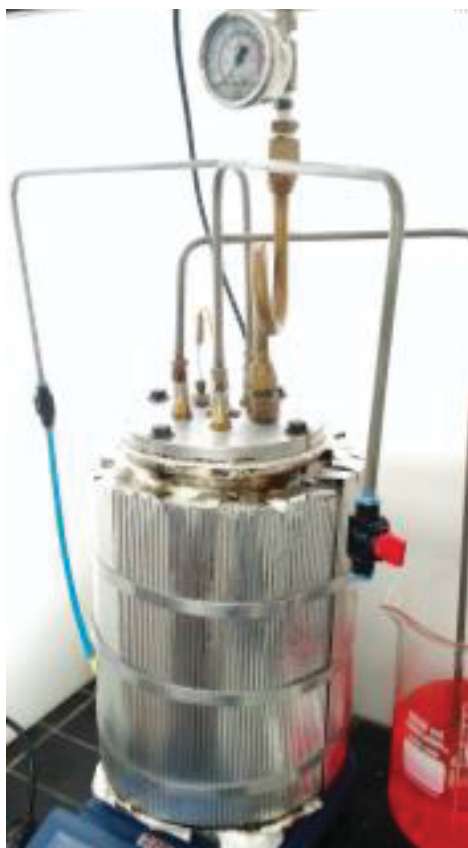
FIGURA 8 - REATOR ELETROQUÍMICO EM USO.
