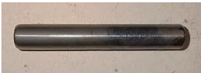
FIGURA 23 - FILME ESCURO SOBRE A SUPERFÍCIE DO ELETRODO DE TRABALHO (ASTM A335P5) APÓS TESTES COM NAT 2,5 mg KOH g -1 .
