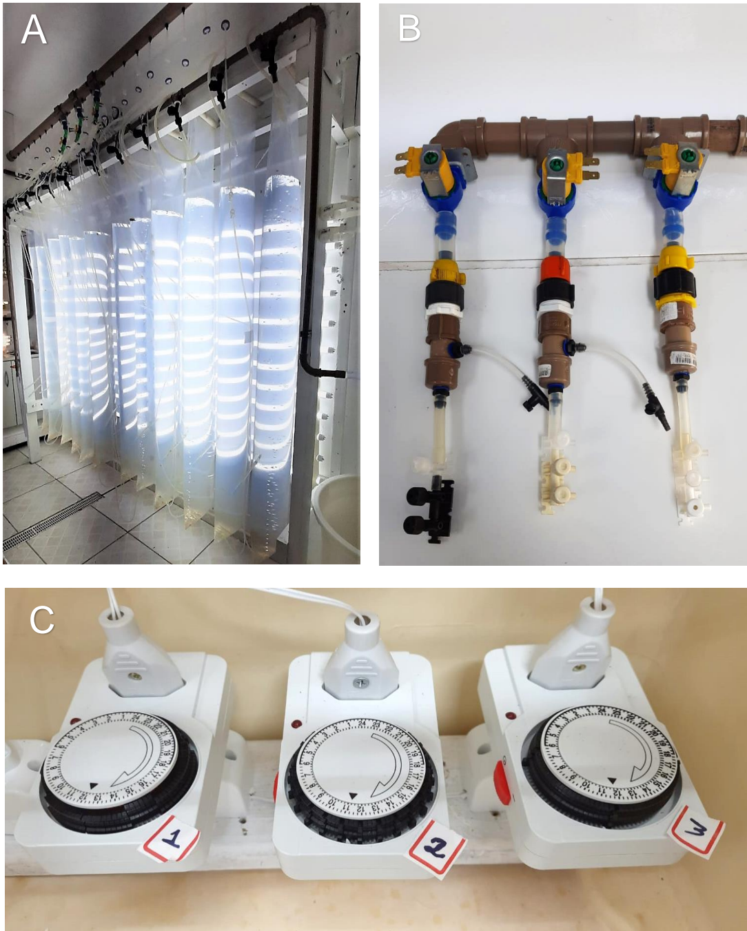
Figura 5: A) Fotobiorreator com bolsas de polipropileno suspensas. B) Sistema hidráulico com válvulas solenoides e registros para controle de aeração. C) Temporizadores utilizados para controlar o período de entrada de aeração nos cultivos.
