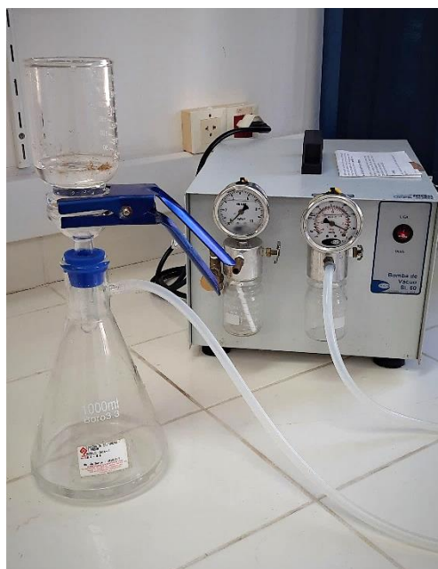
Figura 2: Processo de filtração a vácuo em filtro de fibra de vidro.
