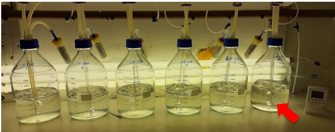
Figura 12: Sistema de cultivo em garrafas com capacidade de 2000 ml e com inserção de aeração forçada.
