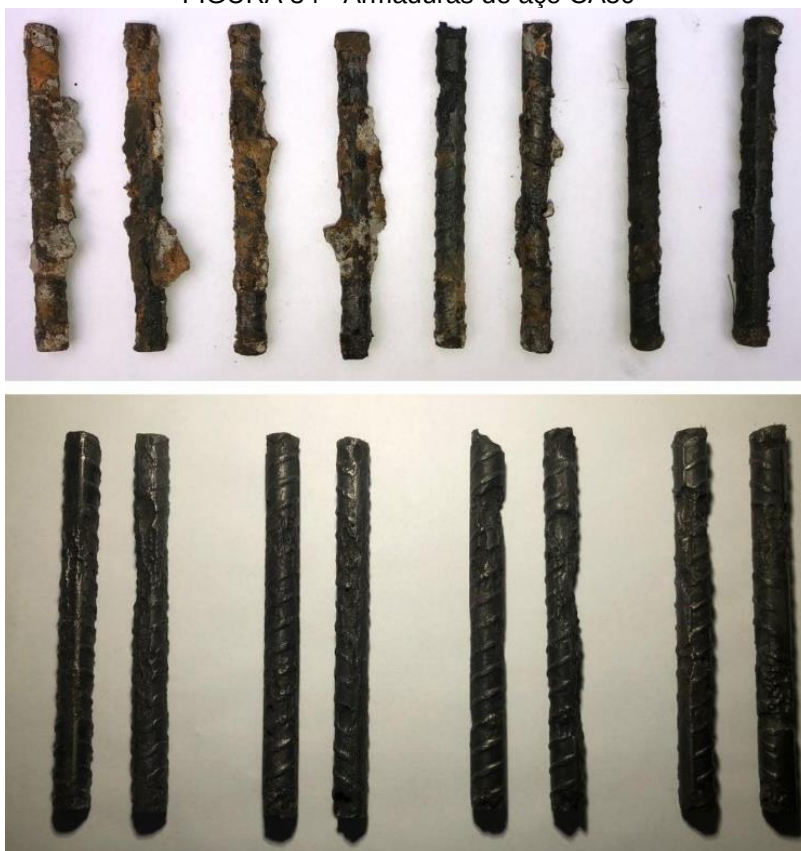
FIGURA 34 - Armaduras de aço CA50
