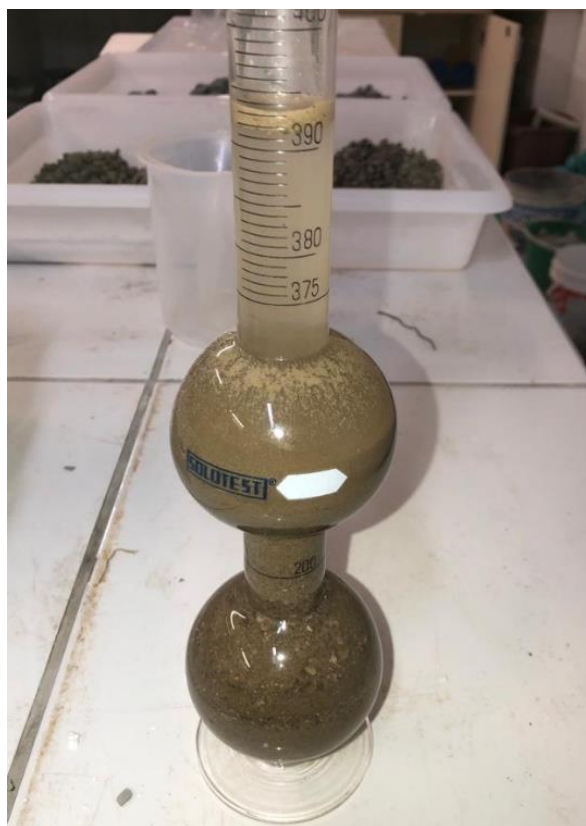
FIGURA 30 - Massa específica da areia
