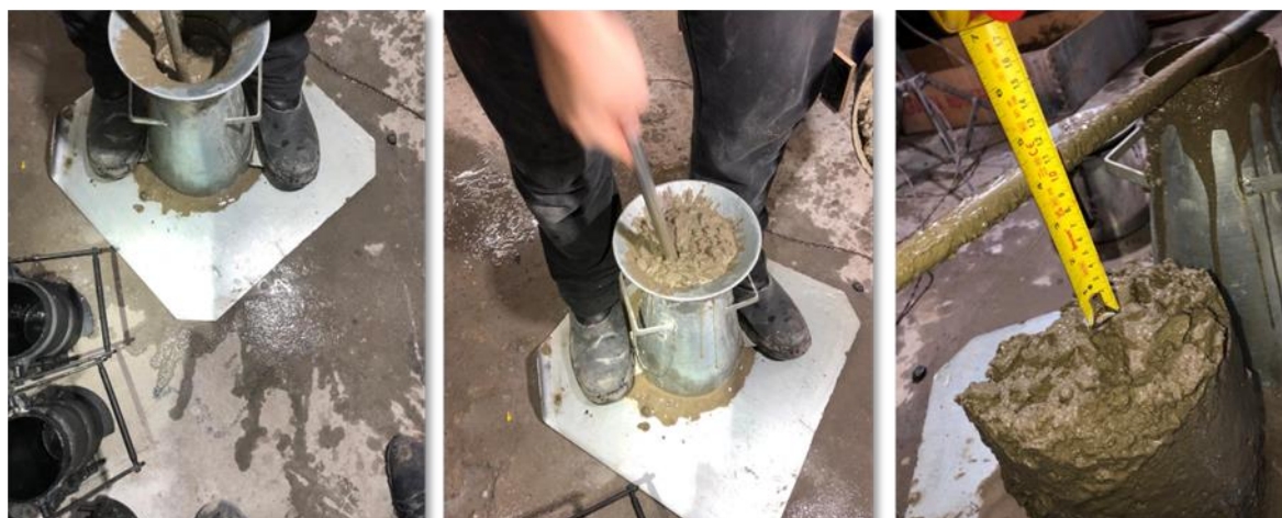
FIGURA 4 - Abatimento do tronco de cone
