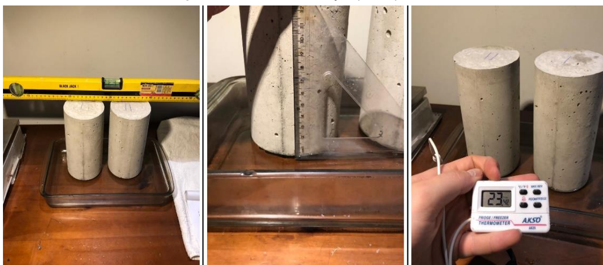
Figura 9 – Ensaio de absorção por capilaridade
