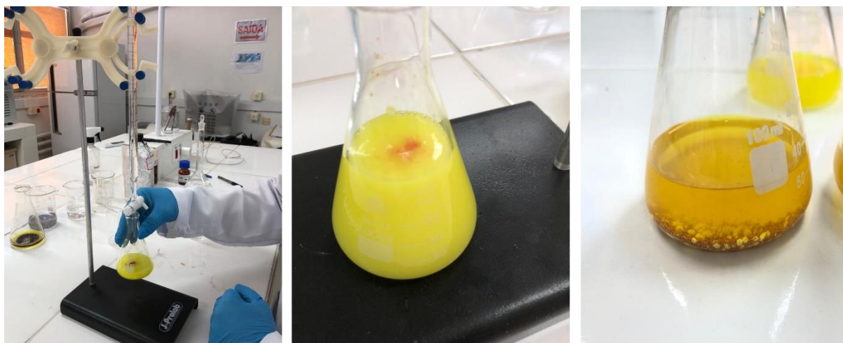
FIGURA 25 - Reação de nitrato de prata com o cloreto de sódio
