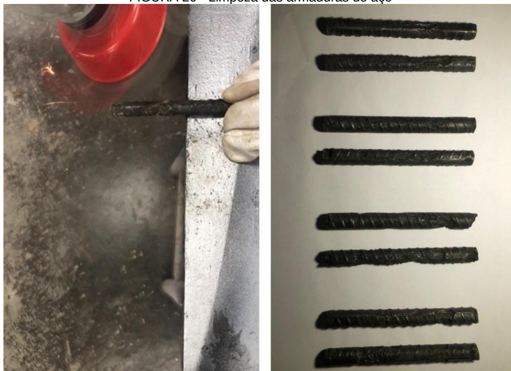
FIGURA 20 - Limpeza das armaduras de aço
