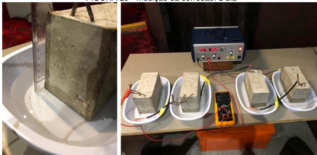
FIGURA 19 - Medição da corrosão: 1 dia
