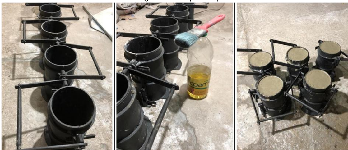
FIGURA 7 - Moldagem dos corpos de prova cilíndricos.
