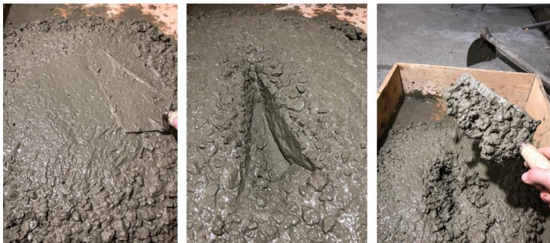
FIGURA 5 - Coesão e consistência (método IPT/EPUSP).
