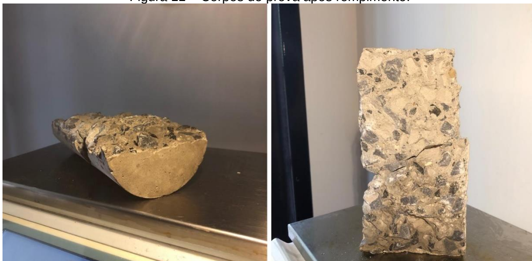
Figura 11 – Corpos de prova após rompimento.
