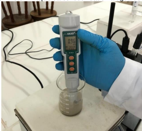
FIGURA 23 - Determinação da condutividade na água do mar
