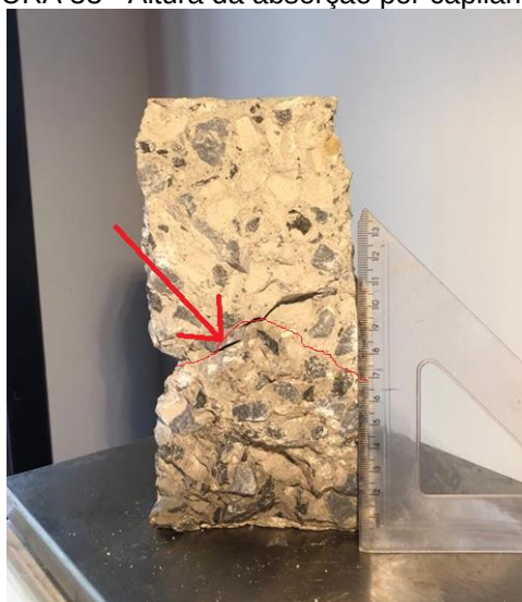
FIGURA 33 - Altura da absorção por capilaridade
