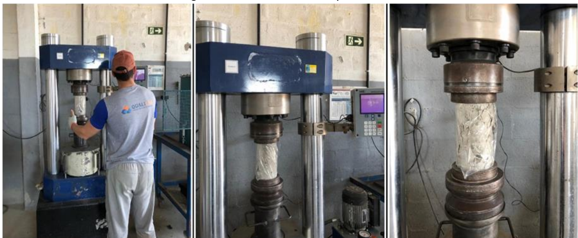
Figura 12 – Ensaio de compressão axial.
