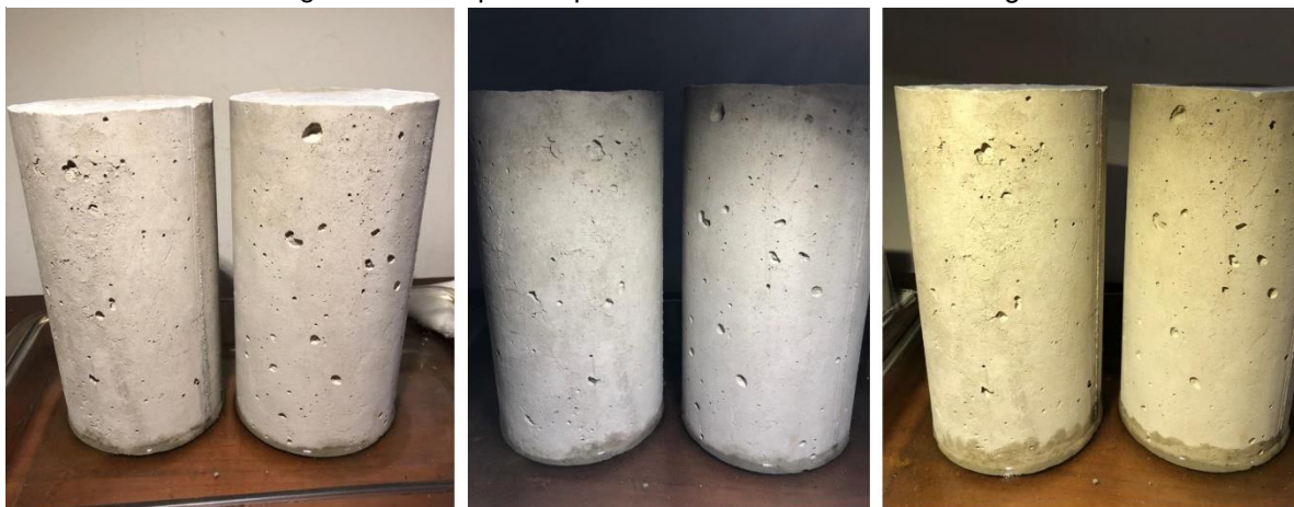
Figura 10 – Corpos de prova em contato com lâmina d'água.
