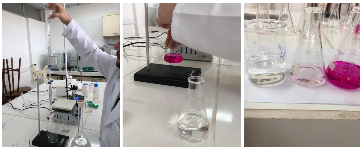
FIGURA 24 - Determinação da alcalinidade
