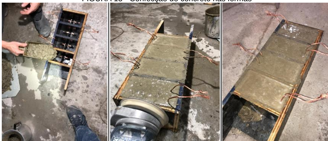
FIGURA 15 - Confecção do concreto nas fôrmas
