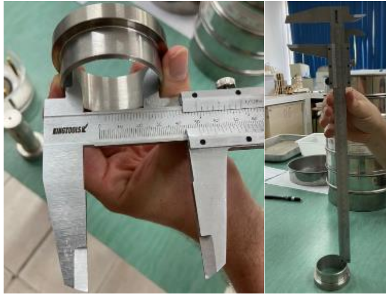
Figuras 13 – Medição das dimensões do anel de adensamento
