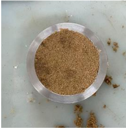
Figura 20 - Amostra de solo contida no anel de adensamento
