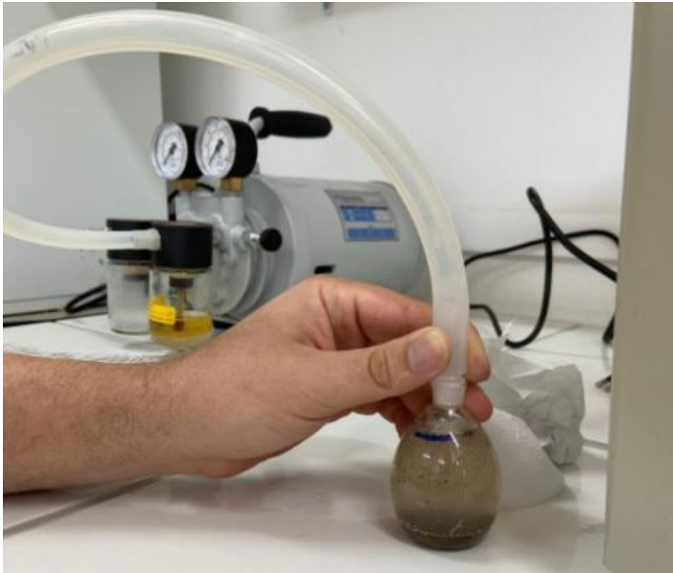
Figura 15 - Retirando o ar do solo com uma bomba de vácuo
