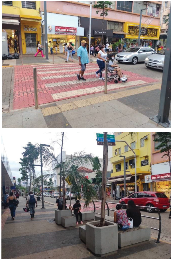
FIGURA 26 – Rua 14 de Julho após revitalização: priorização da mobilidade ativa, acessibilidade, implantação de mobiliário urbano e plantio de vegetação
