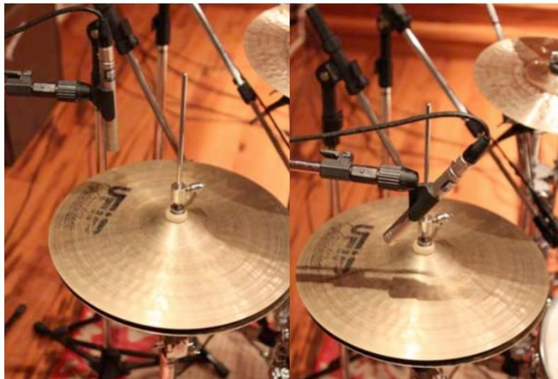
Figura 16 – Microfone de chimbau apontado para baixo (esquerda) e rejeitando a caixa (direita) (Henriques, 2011).
