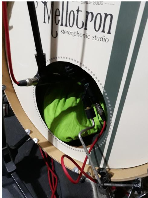
Figura 34: posição g) com SM57 (esquerda) e D112 (direita). Áudios *34-g-SM57* e *34-g-D112*.
