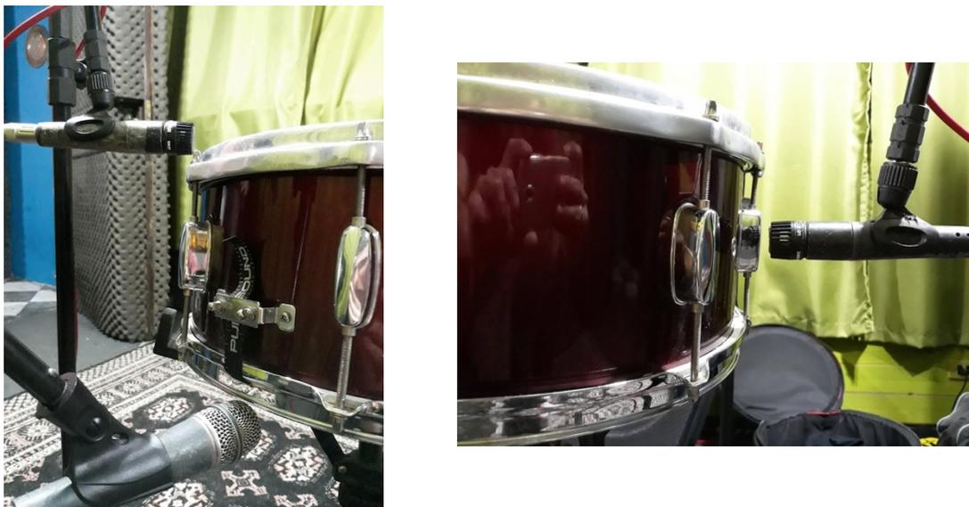
Figura 19 – Microfonação de caixa com técnica descrita por Gil Costa em entrevista (esquerda) e microfonação pela lateral do casco da caixa (direita).
