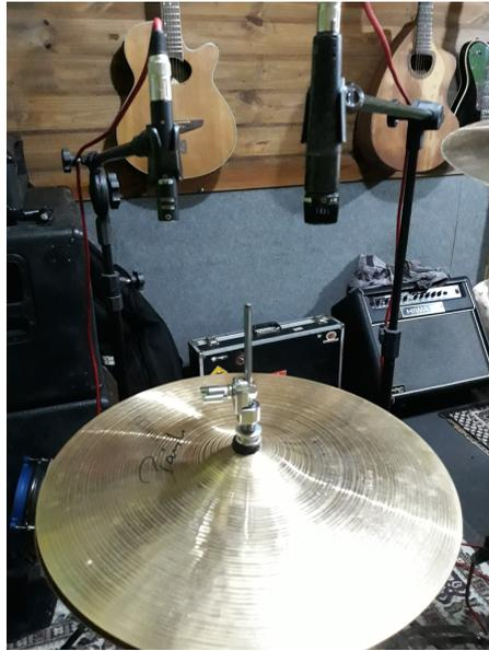
Figura 36: posição i) com CM217 (esquerda) e SM57 (direita). Áudios *36-i-CM217* e *36-i-SM57*.
