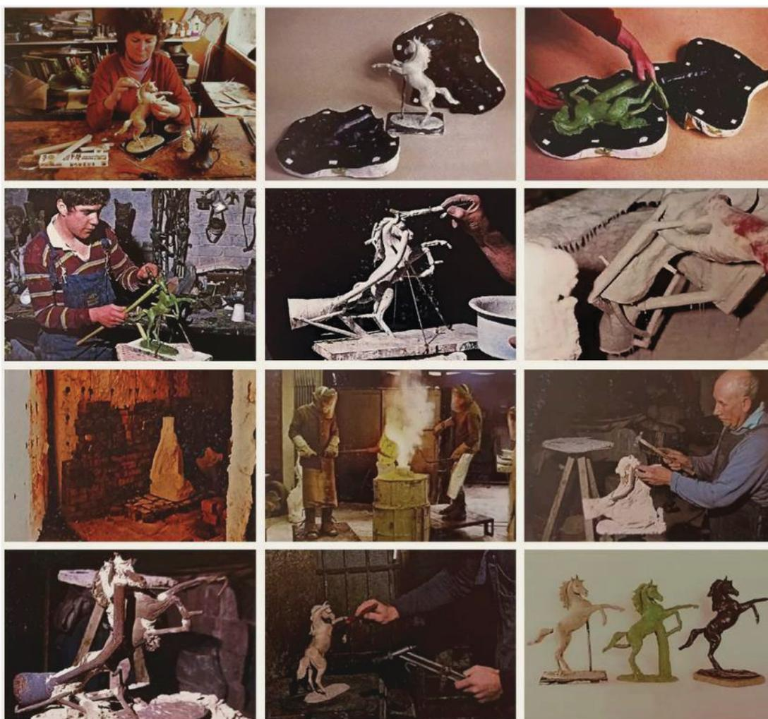
**Figura 112** – Sequência demonstrativa de diversas etapas do método de fundição por cera perdida.
