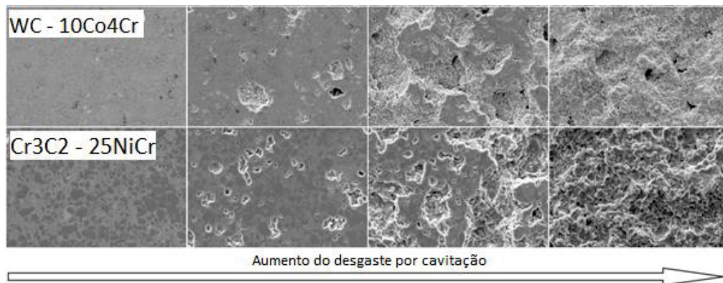
Figura 15 – Desenvolvimento do desgaste por cavitação dos revestimentos de WC e Cr 3 C 2 .
