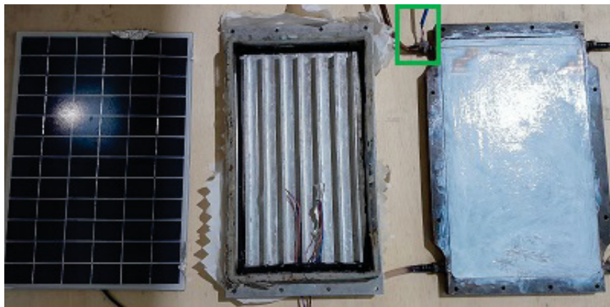
FIGURA 21 – COMPONENTES DO SISTEMA FVT+MMF
