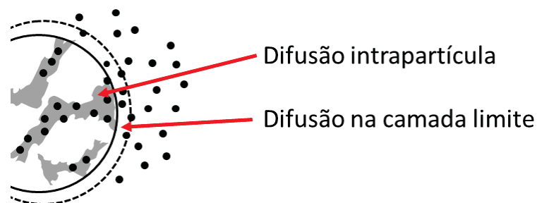
FIGURA 2.8 – REPRESENTAÇÃO ESQUEMÁTICA DO MECANISMO DE SORÇÃO POR DIFUSÃO INTRAPARTÍCULA.
