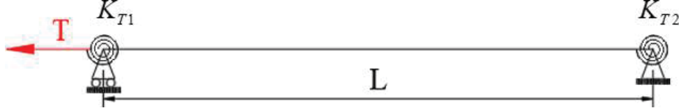
FIGURA 16 – VIGA APOIADA COM MOLAS TORCIONAIS NAS EXTREMIDADES
