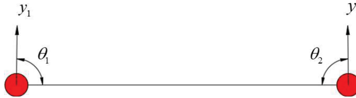
FIGURA 17 – REPRESENTAÇÃO ESQUEMÁTICA DE UM ELEMENTO DE EULER - BERNOULLI COM DOIS GRAUS DE LIBERDADE POR NÓ
