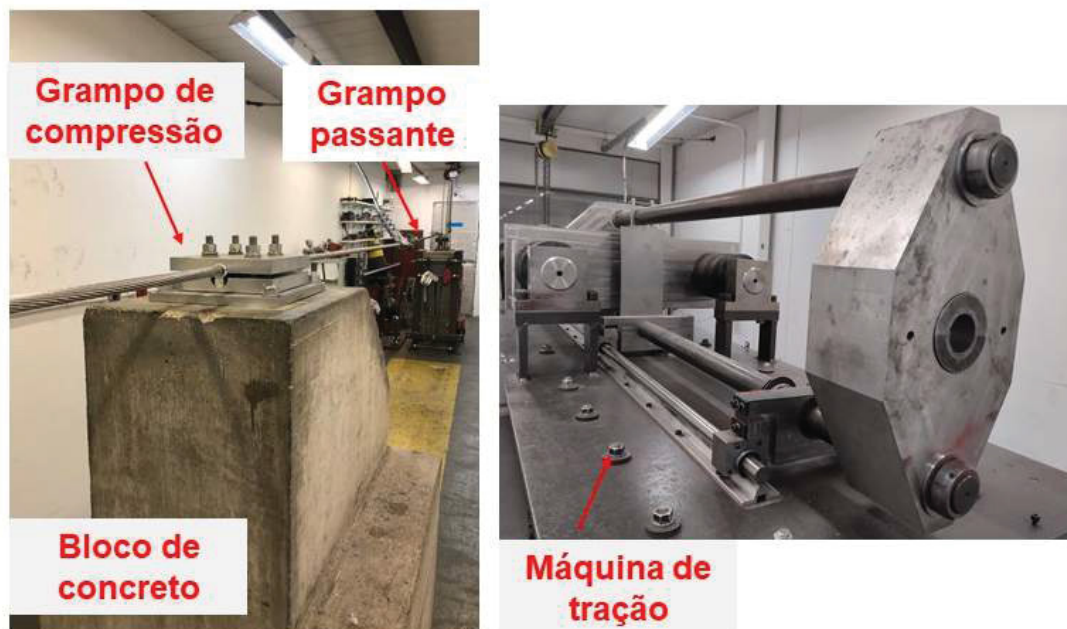
FIGURA 19 – MÁQUINA DE TRAÇÃO E EXTREMIDADES DE FIXAÇÃO
