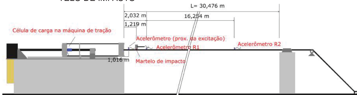
FIGURA 24 – ILUSTRAÇÃO DA CONFIGURAÇÃO EXPERIMENTAL DO ENSAIO POR MARTELO DE IMPACTO
