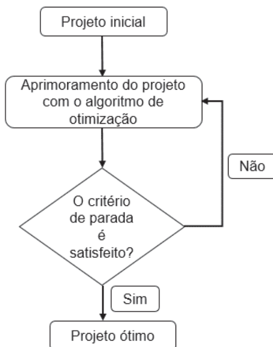
FIGURA 97 – FLUXOGRAMA GENÉRICO DE UM PROCESSO DE OTIMIZAÇÃO
