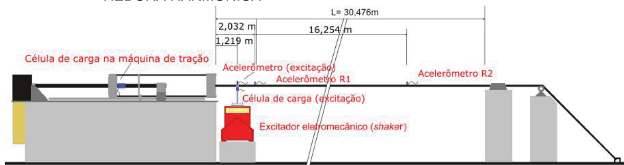
FIGURA 23 – ILUSTRAÇÃO DA CONFIGURAÇÃO EXPERIMENTAL DO ENSAIO POR VARREDURA HARMÔNICA
