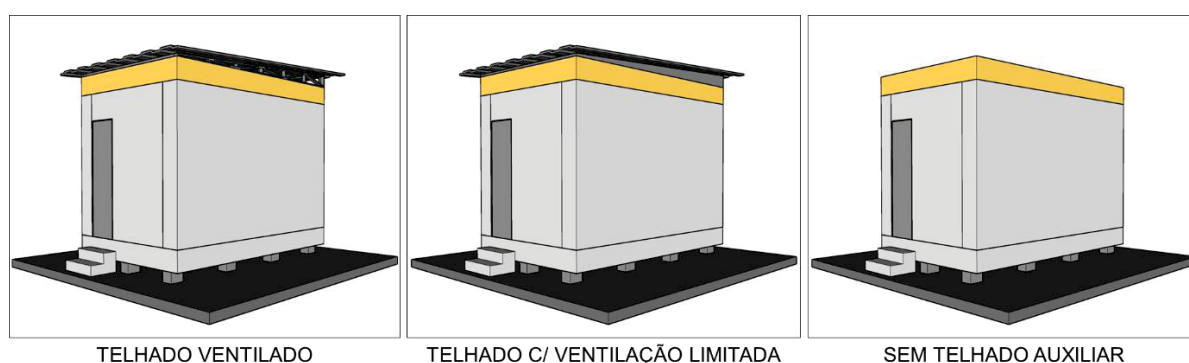
FIGURA 68 – Testes com elementos de cobertura
