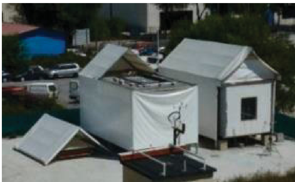
FIGURA 32 – Sistema de sombreamento com lona na célula-teste Paslink
