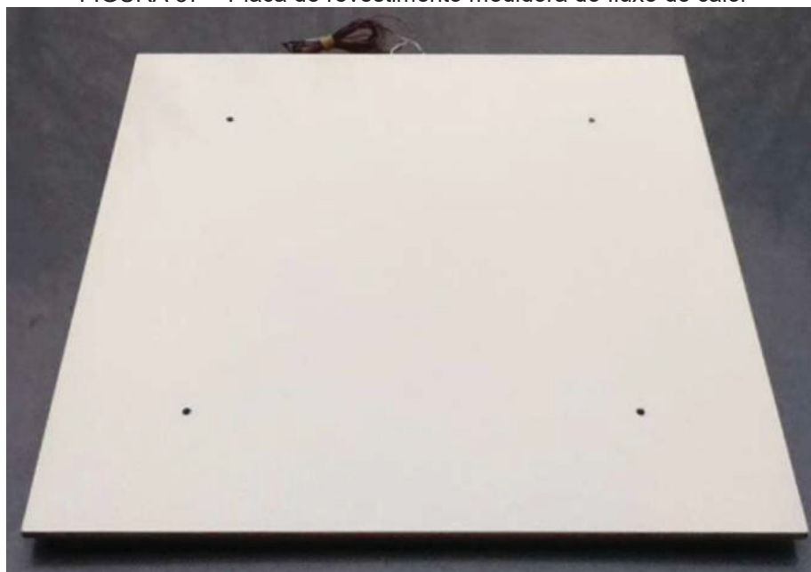
FIGURA 37 – Placa de revestimento medidora do fluxo de calor
