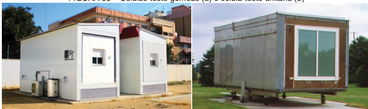
FIGURA 33 – Células-teste gêmeas (a) e célula-teste unitária (b)
