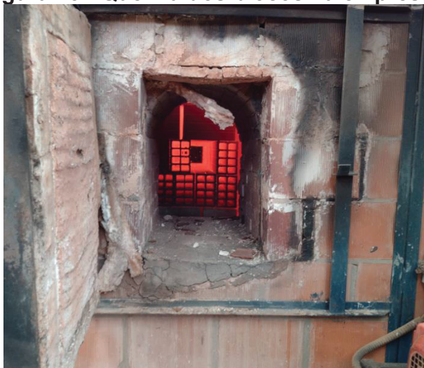
Figura 23 - Queima dos blocos na empresa 4
