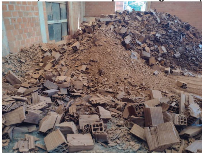
Figura 26 - Peças danificadas após a secagem - empresa 4
