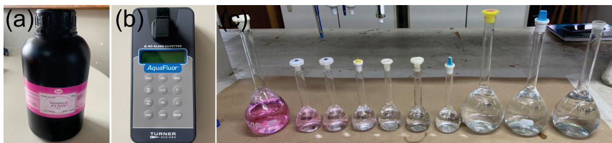
Figura 15 – (a) Corante Rodamina B e (b) fluorímetro AquaFluor® da Turner Designs utilizado nos experimentos, e a (c) curva de concentração do traçador Rodamina B utilizada para calibrar o fluorímetro.
