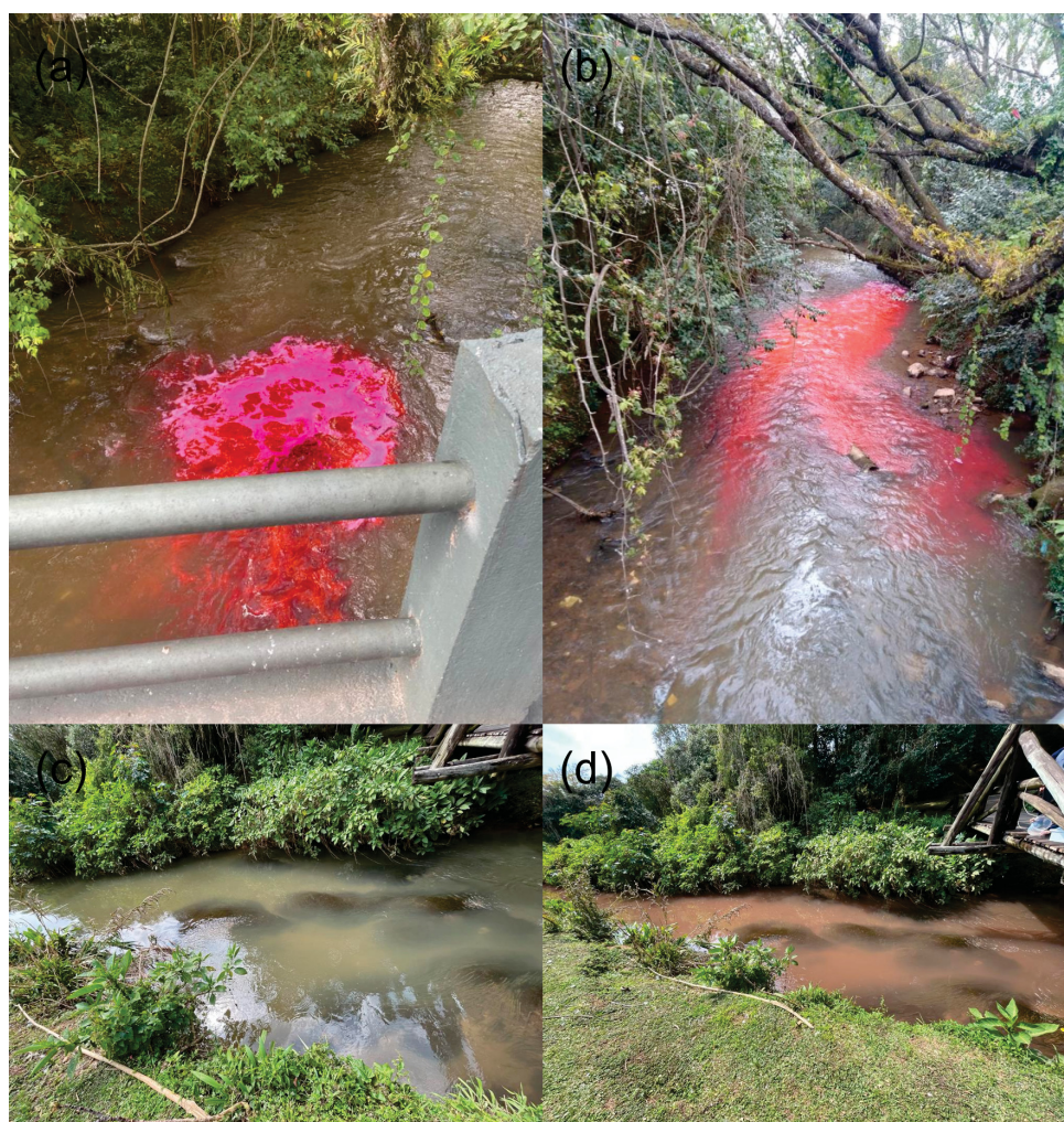
Figura 16 – Imagens do lançamento do traçador no rio Barigui (a), início da mistura (b) e no ponto P2 antes (c) e durante (d) a passagem da pluma do traçador, no dia 02/09/2022.
