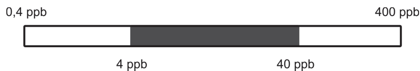
Figura 14 – Ilustração da faixa de detecção do fluorímetro e a faixa desejável de medição estabelecida.
