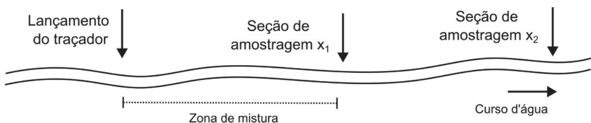
Figura 4 – Esquema do experimento com uso de traçadores, com duas seções de amostragem x_1 e x_2 .
