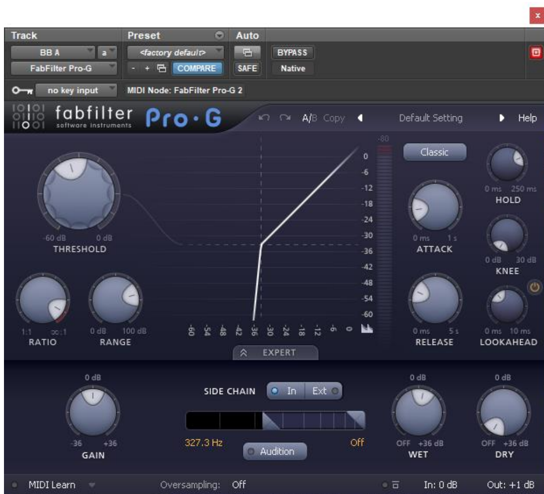
Figura 44 – Gate no canal do bumbo agudo Fonte: Pro Tools HD 12
