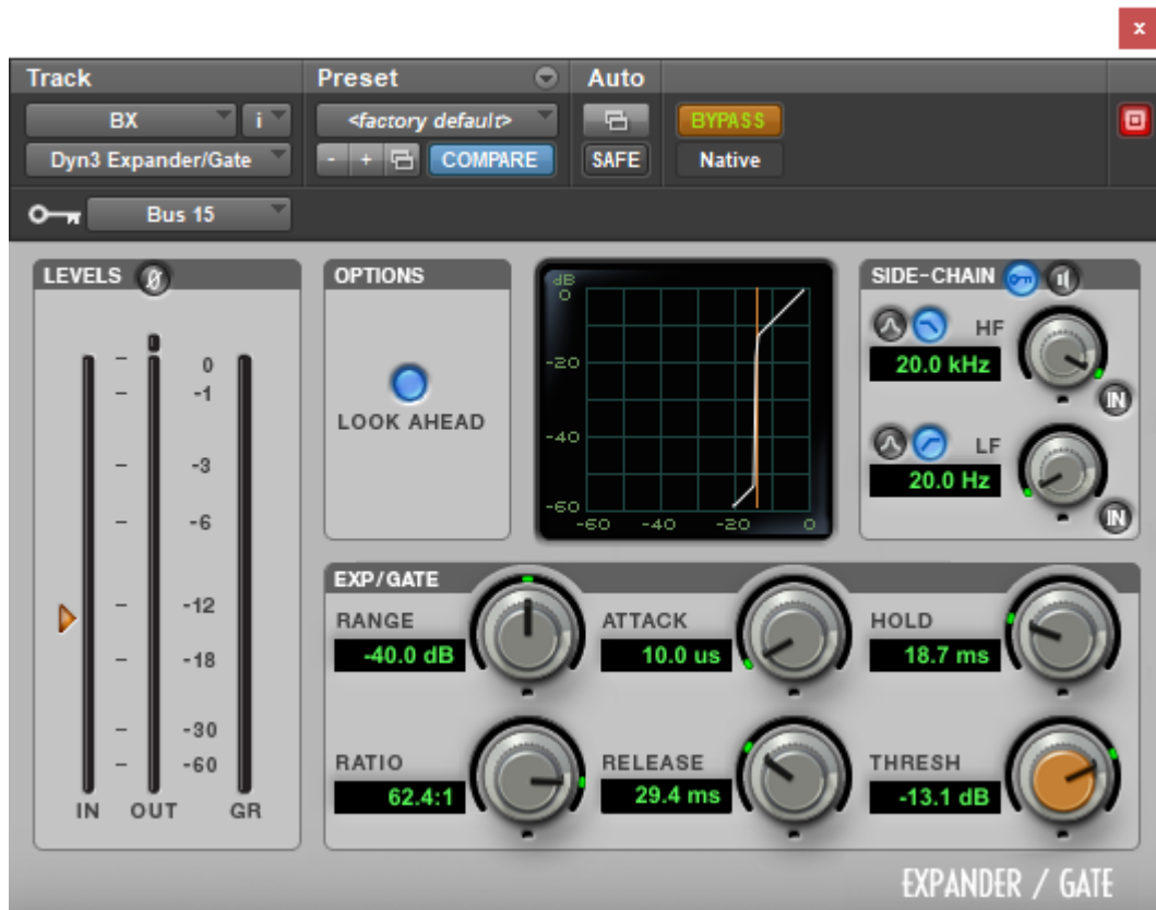
Figura 45 – Gate usado no contrabaixo elétrico com side-chain vindo do canal da guitarra
