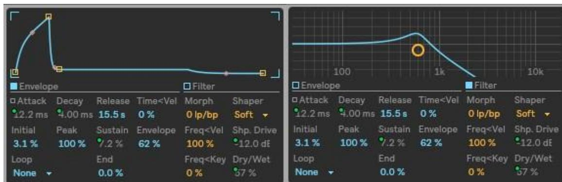
Figura 13 – Configurações dos parâmetros referentes ao filtro presente no sintetizador
