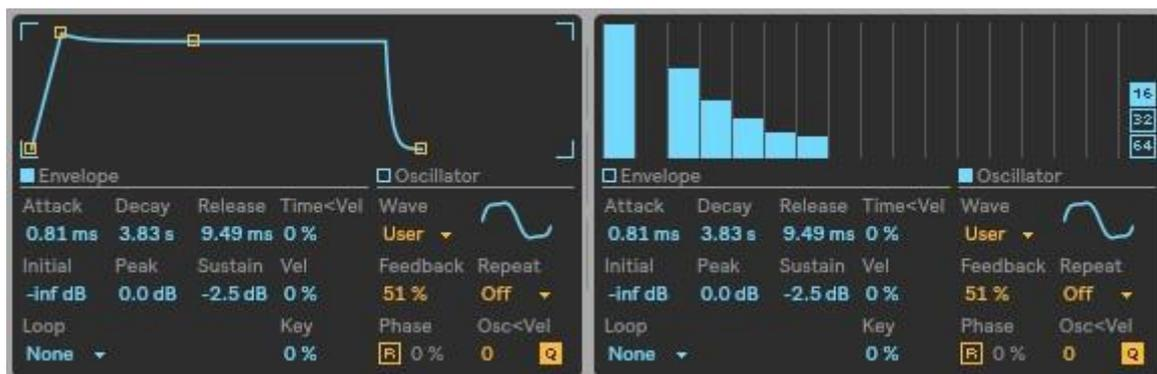
Figura 9 – Oscilador B: configurações dos parâmetros relativos ao envelope e aos harmônicos, respectivamente.
