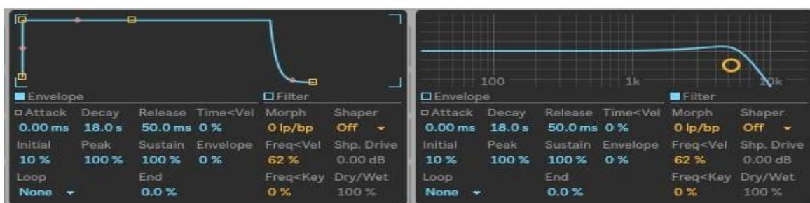
Figura 119 – Ajustes dos parâmetros referentes ao filtro presente no sintetizador
