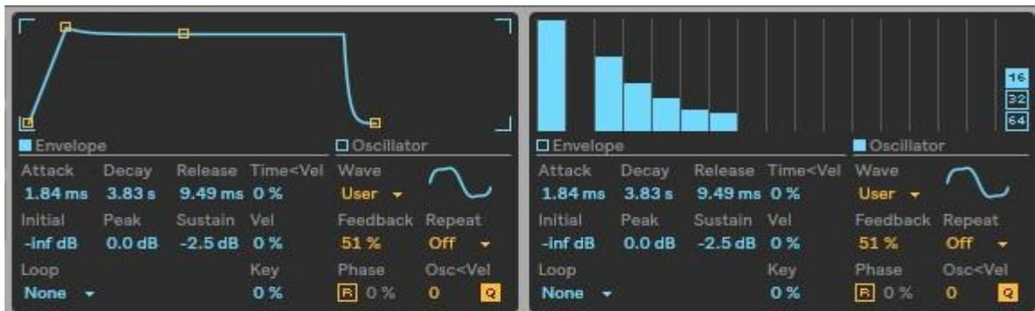
Figura 52 – Oscilador B: ajustes dos parâmetros referentes ao envelope e aos harmônicos, respectivamente
