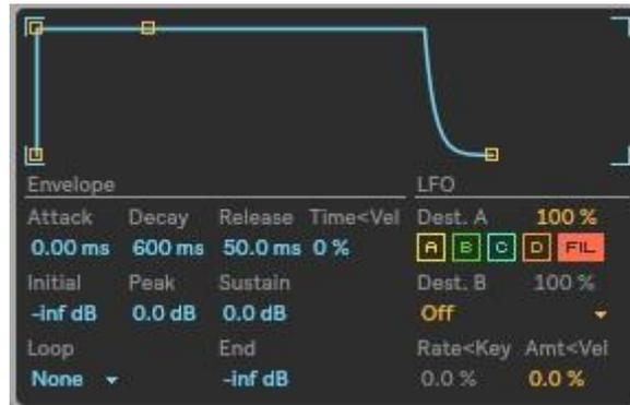
Figura 30 – Ajustes dos parâmetros referentes ao oscilador de baixas frequências presente no sintetizador
