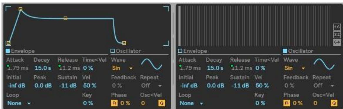
Figura 80 – Oscilador B: ajustes dos parâmetros referentes ao envelope e aos harmônicos, respectivamente
