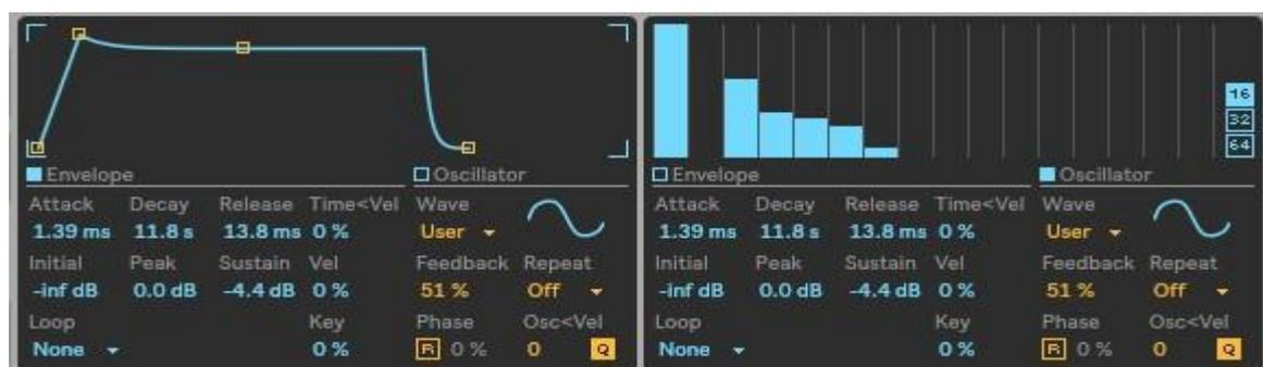
O segundo sintetizador constituinte do timbre que executa a harmonia de base da peça é composto por 4 osciladores. Destes, dois são de ondas senoidais, um é de onda dente de serra com 64 harmônicos e o último é de uma onda que contém apenas a fundamental e o quinto harmônico. As configurações dos osciladores estão evidenciadas nas imagens abaixo.
