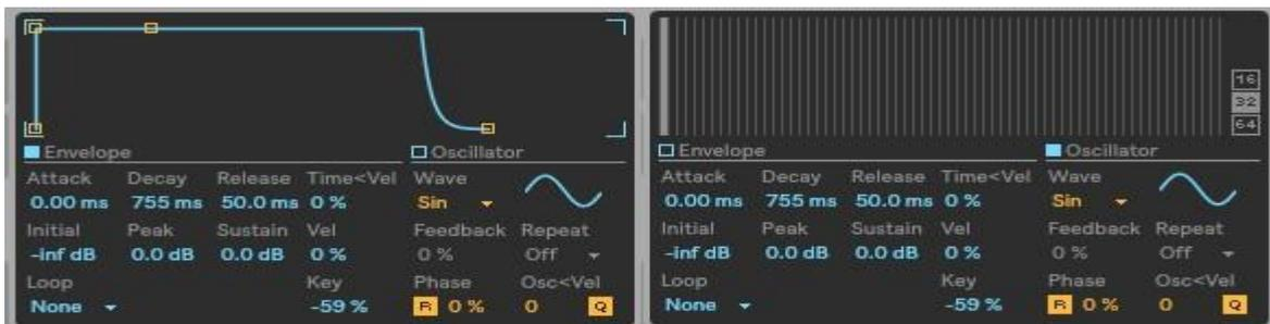
Figura 76 – Oscilador C: ajustes dos parâmetros correspondentes ao envelope e aos harmônicos, respectivamente
