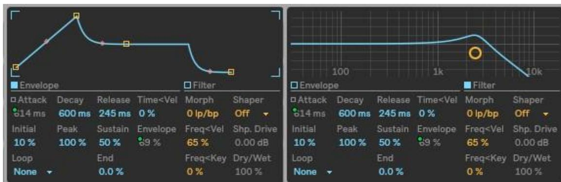
Figura 175 – Parâmetros referentes às configurações aplicadas no filtro presente no sintetizador
