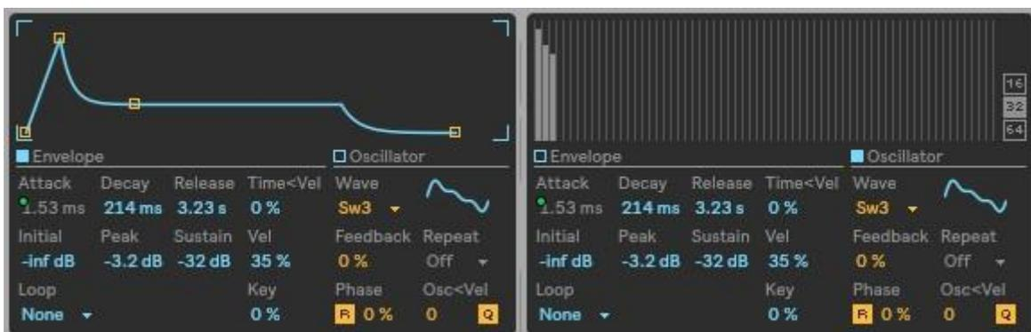
Figura 96 – Oscilador C: ajustes dos parâmetros referentes ao envelope e aos harmônicos, respectivamente
