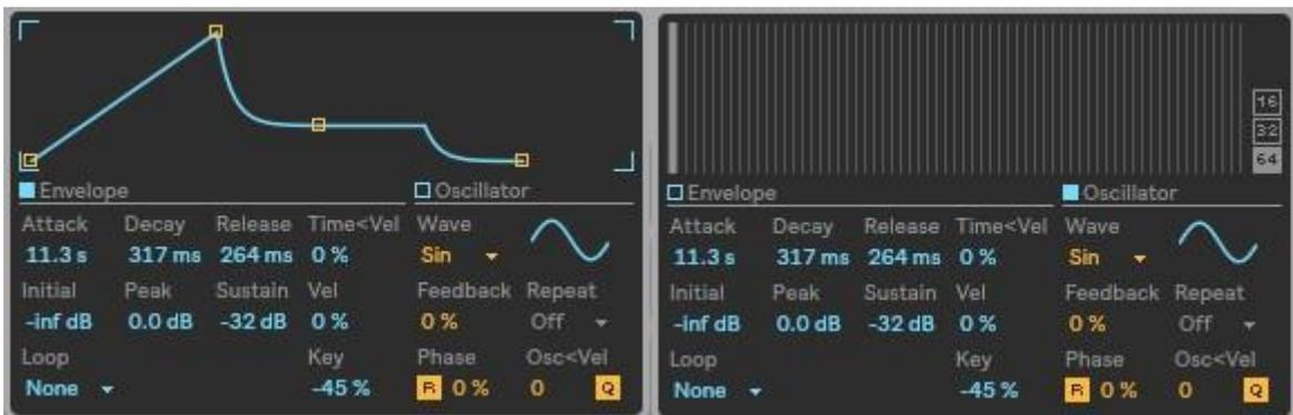
Há, ainda, nesse sintetizador, a presença de um filtro que interfere em seu timbre. Nas imagens abaixo são demonstradas as configurações utilizadas em seus parâmetros.
