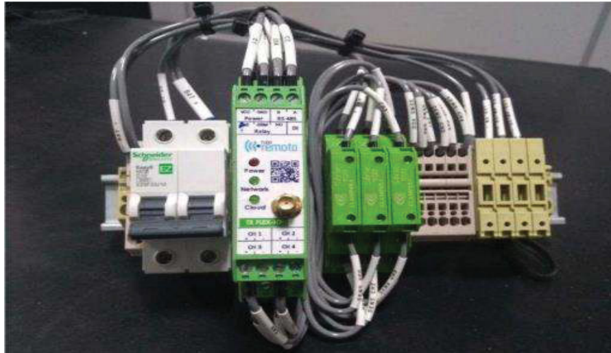
Figura 21. Kit Hardware de Monitoramento e Controle (Kit MPA)
