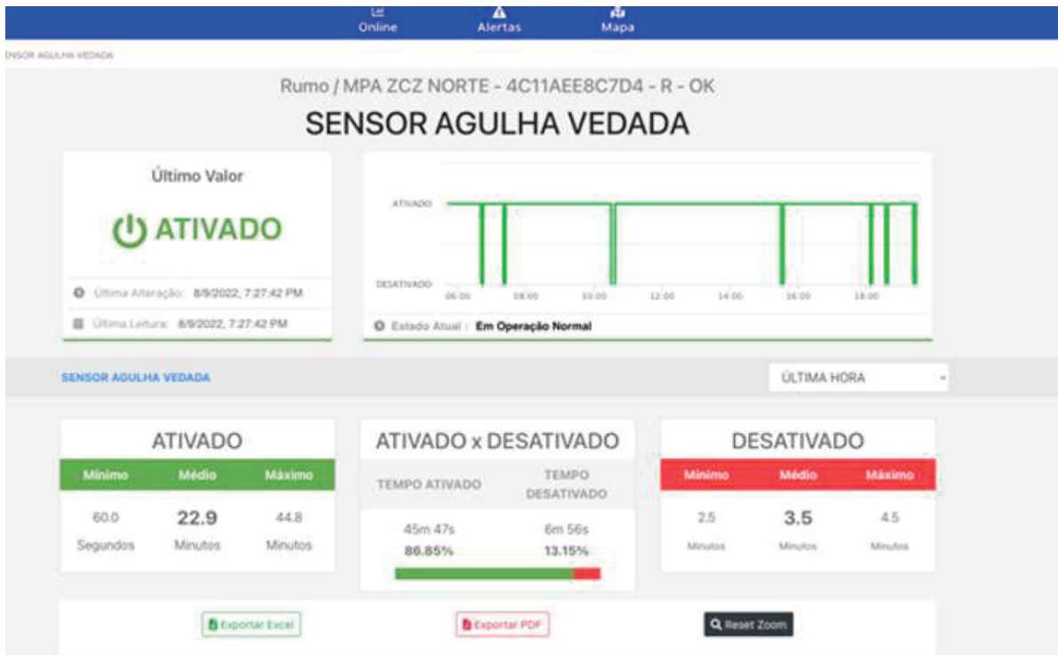
Figura 27. Tela gerada pela plataforma supervisória com os status do ponto
