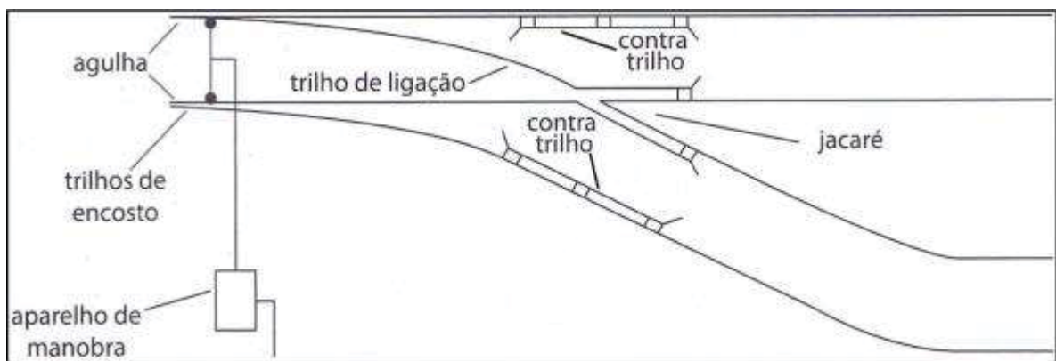
Figura 3. Componentes de um Aparelho de Mudança de Via - AMV.
