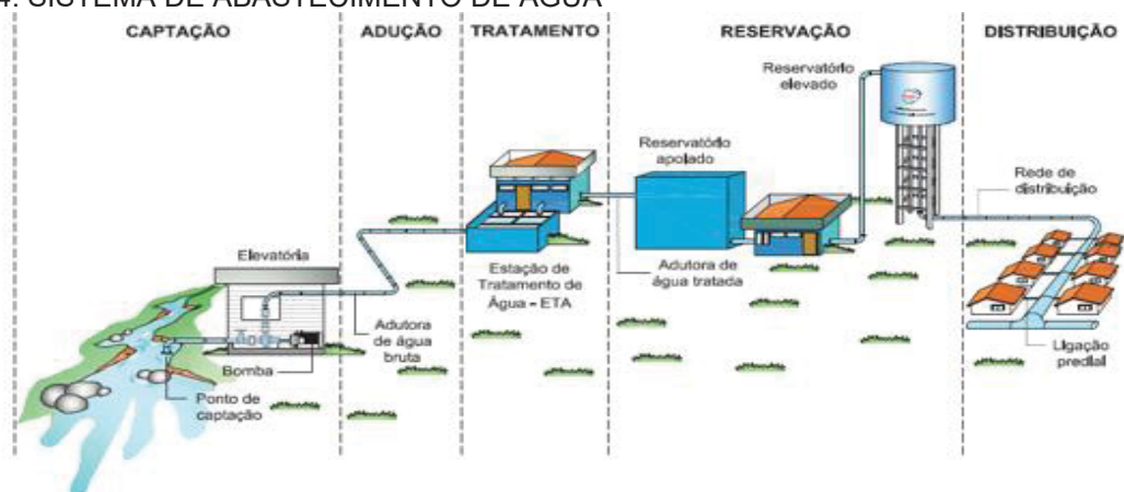
FIGURA 4: SISTEMA DE ABASTECIMENTO DE ÁGUA
