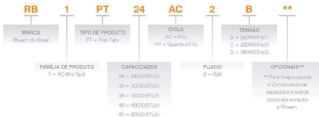
FIGURA 2.10 - Descrição do esquema de código dos equipamentos RHEEM
