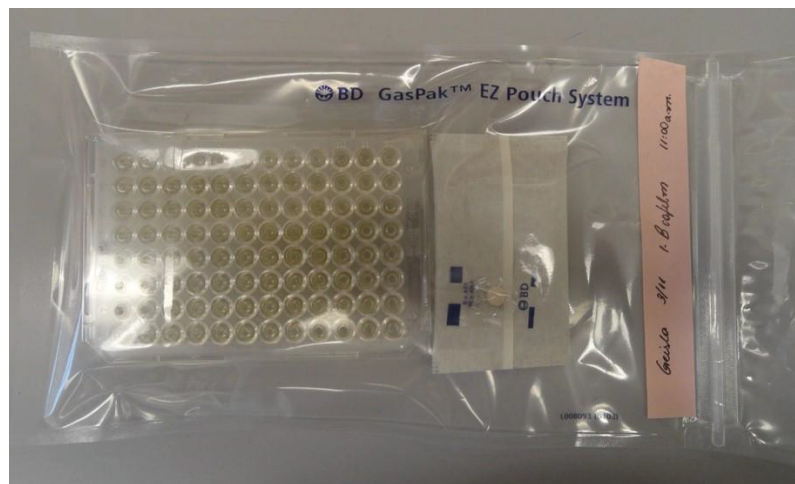
Figura 2 Sistema BD GasPak EZ para estabelecimento da condição atmosférica de anaerobiose
