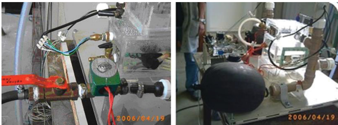
Figura 2.16 - Válvula solenoide (esquerda) e protótipo do sistema de aquecimento e umidificação de ar acoplado a um pulmão-teste artificial de borracha (direita).
