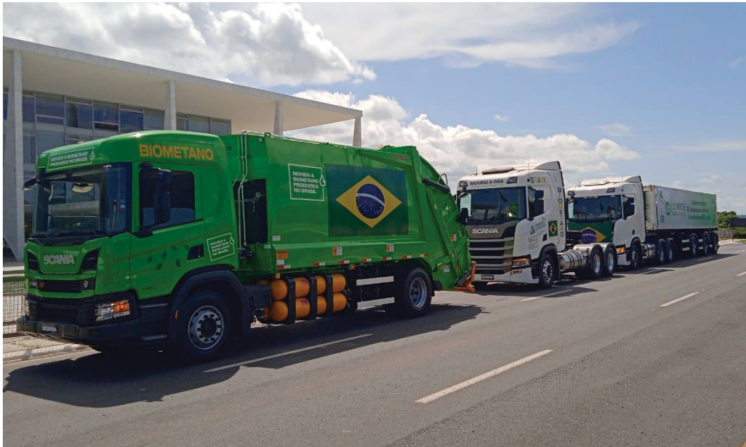
FIGURA 4 – CAMINHÃO COMPACTADOR DE RESÍDUOS MOVIDO A GÁS
