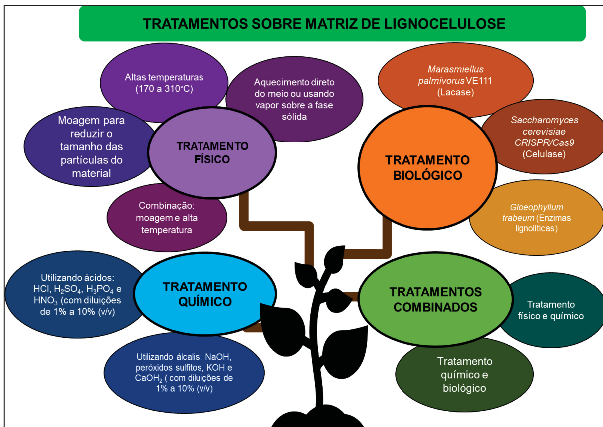
Figura 1. Representação de tratamentos que podem ser aplicados para modificar e gerar produtos a partir de biomassas lignocelulósicas.
