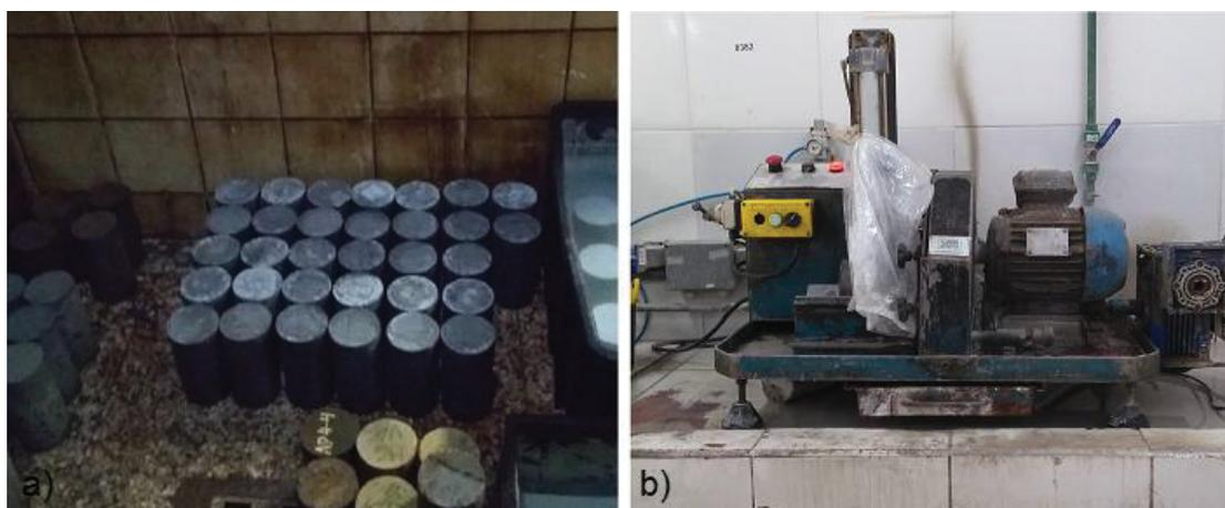
a) Corpos de prova na câmara úmida b) Retífica utilizada para retificação dos corpos de prova
