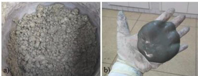
a) Pasta com quantidade de água insuficiente b) Pasta com consistência ideal para a densidade de empacotamento máxima
