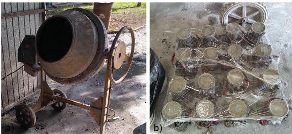
a) Betoneira com capacidade de 120 litros b) Corpos de prova recém moldados
