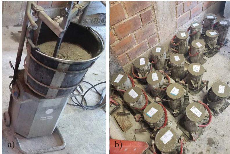
a) Misturador de 20 litros b) Corpos de prova recém-produzidos
