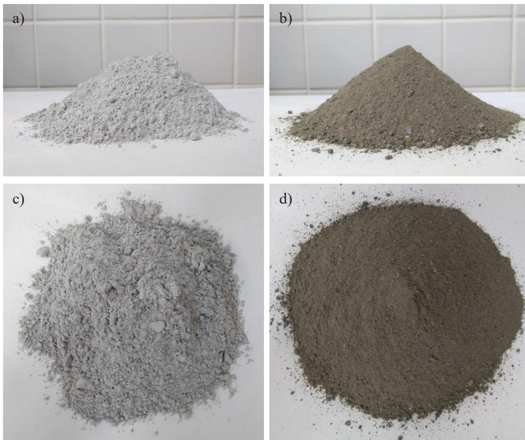
a) Pó de calcário vista frontal b) Pó de diabásio vista frontal c) Pó de calcário visto de cima d) Pó de diabásio visto de cima
