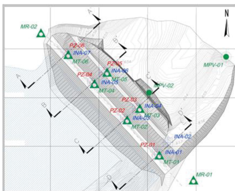
FIGURA 4.10 Planta da instrumentação do Dique 2
