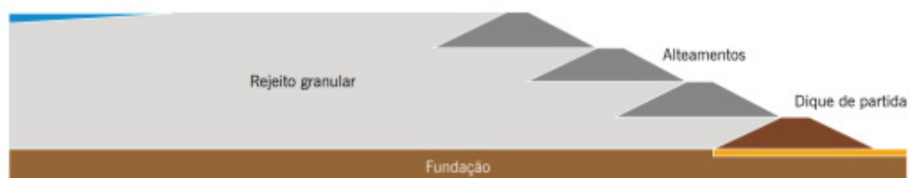
FIGURA 2.3 - Método construtivo de alteamento a montante
