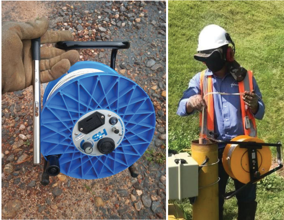
FIGURA 2.7 – Leitura do nível d'água com pio elétrico
