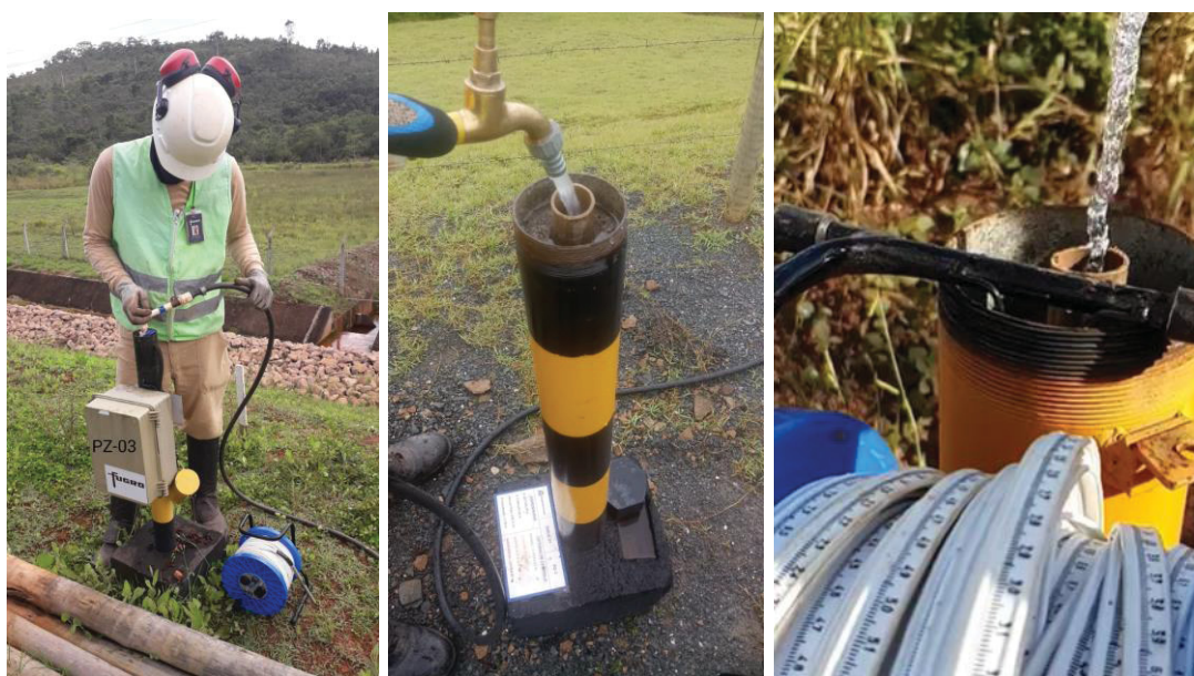
FIGURA 3.3 Ensaio de rebaixamento
