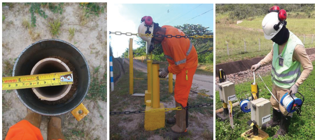
FIGURA 3.4 Verificações em campo dos piezômetros
