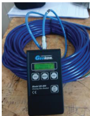
FIGURA 3.7 Exemplo de equipamento utilizado para aquisição manual dos dados
