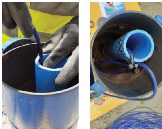
FIGURA 3.12 Marcação do comprimento do instrumento no cabo do sensor
