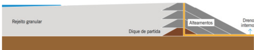
FIGURA 2.2 - Método construtivo de alteamento de linha de centro
