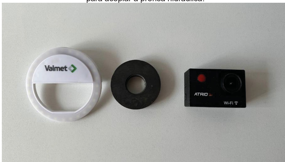
FIGURA 30 – Anel de luz, imã e câmera compondo o módulo de fixação e iluminação necessários para acoplar à prensa hidráulica.
