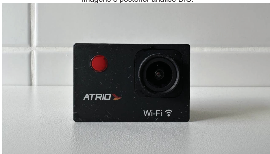
FIGURA 29 – Câmera modelo esportiva portátil utilizada dentro da prensa hidráulica para captura de imagens e posterior análise DIC.
