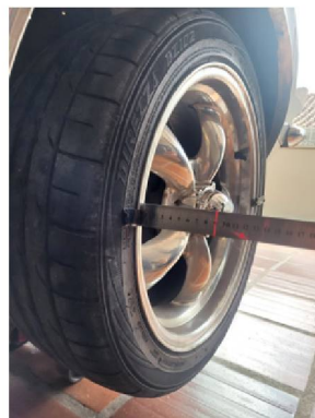
Figura 14 – Medição da distância da face do pneu ao plano de referência para determinação do ângulo de convergência
