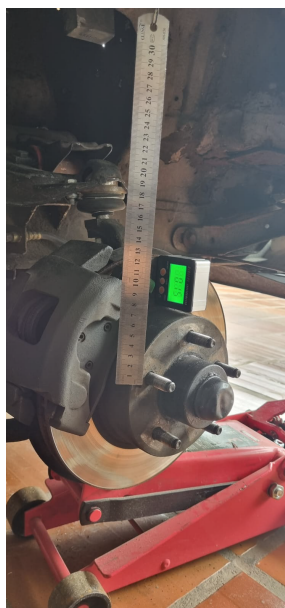
Figura 12 – Arranjo de medição com escala para determinação do curso e inclinômetro para o ângulo de câmber
