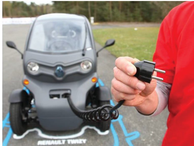
FIGURA 6: RENAULT TWIZY COM CABO PARA CARREGAMENTO RESIDENCIAL, USANDO MODO 1 OU 2
