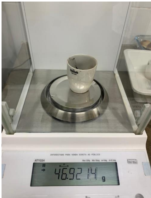
Figura 3 - Pesagem das amostras durante a análise de matéria orgânica
