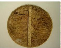
FIGURA 50 - PAREDE DE TERRA-PALHA UNIDADE EXPERIMENTAL 002 (SÃO CARLOS). FONTE: A autora (2012)
