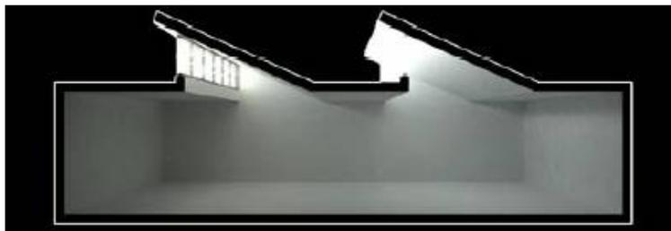
FIGURA 140 – Componente de passagem zenital: *sheds*
