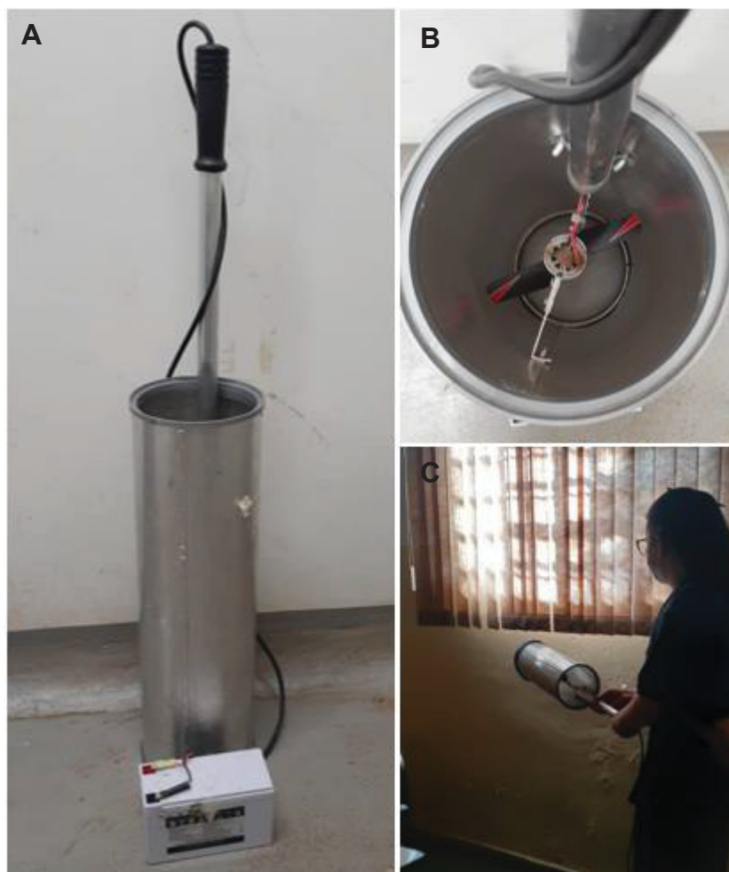
Figura 12- A: Aspirador do Tipo Nasci utilizado para aspiração dos mosquitos, conectado a bateria. B: interior do aspirador de Nasci. C: utilização do aspirador de Nasci em campo. Fonte: o autor.
