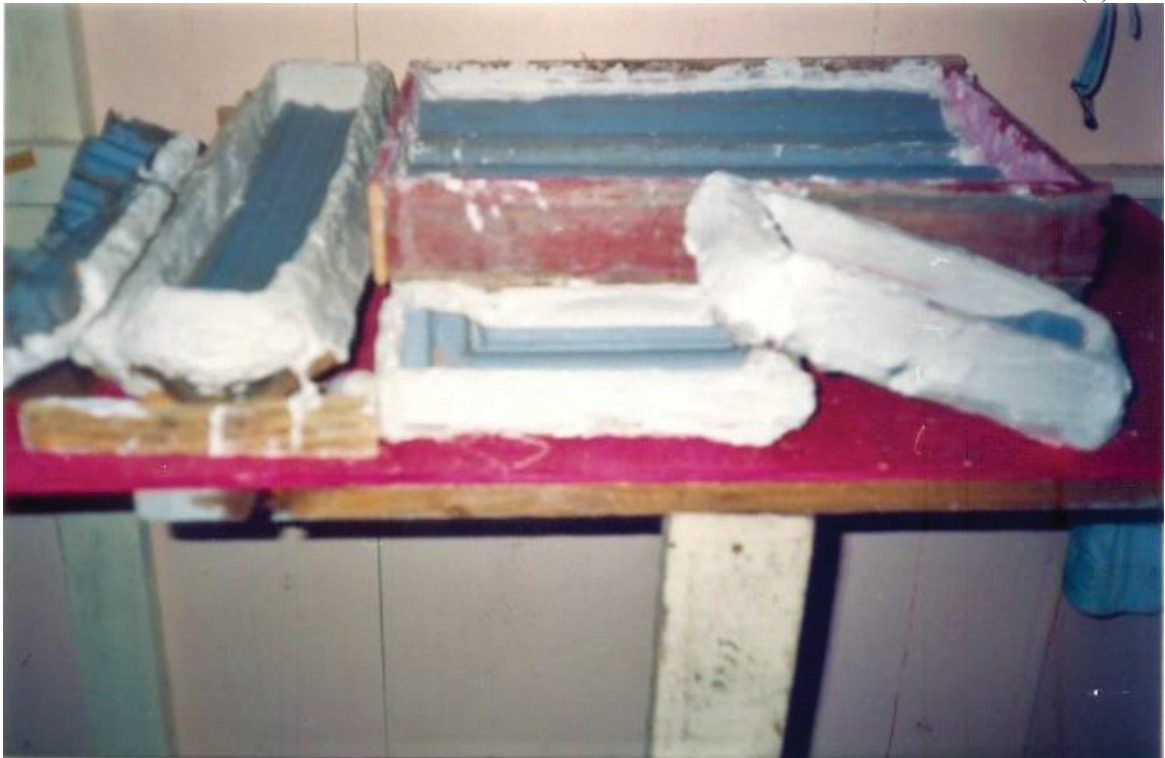
FIGURA 22 – MOLDES PARA ELEMENTOS DECORATIVOS DA FACHADA EXTERNA (1)
