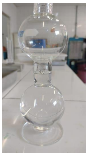
Figura 3.22: Frasco de Chapman com água até a marca 200cm 3 .
