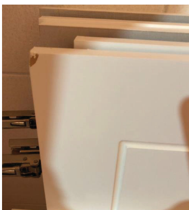
Figura 2 - Exemplo de avaria em quina amassada
