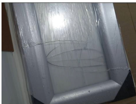
Figura 3 - Exemplo de avaria em peça de vidro
