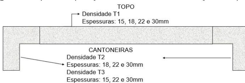
Figura 6 - Esquema de proteção cantoneira em EPS + Proteção de Topo
