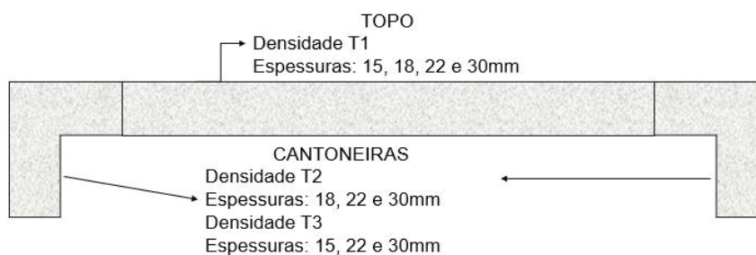
Figura 8 - Esquema de proteção cantoneira em EPS + Proteção de Topo
