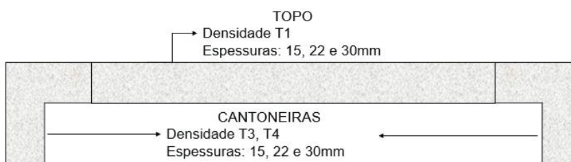
Figura 4 - Esquema de proteção cantoneira em EPS + Proteção de Topo
