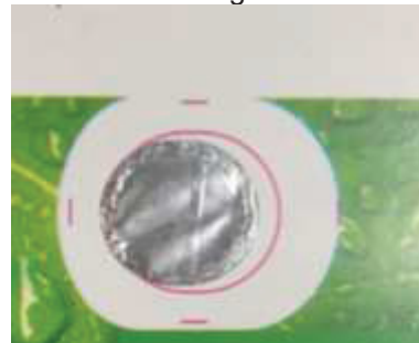
Figura 5 - Swift fora de posição durante a variação de registro
