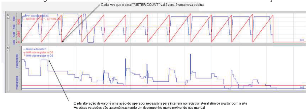
Figura 41 – Evidência 01: Falta de alinhador em materiais com furo na estação 1
