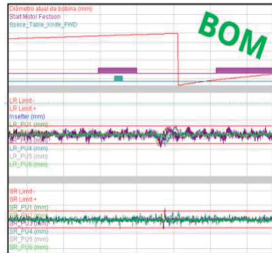
Figura 3 - Pouca Variação de Registro na troca de bobina
