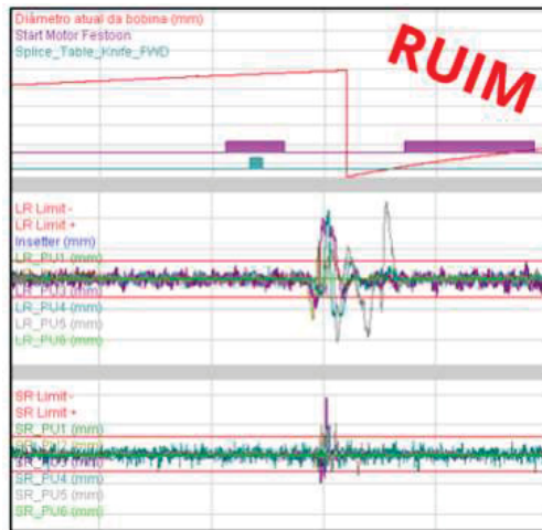
Figura 2 - Muita variação de registro na troca de bobina
