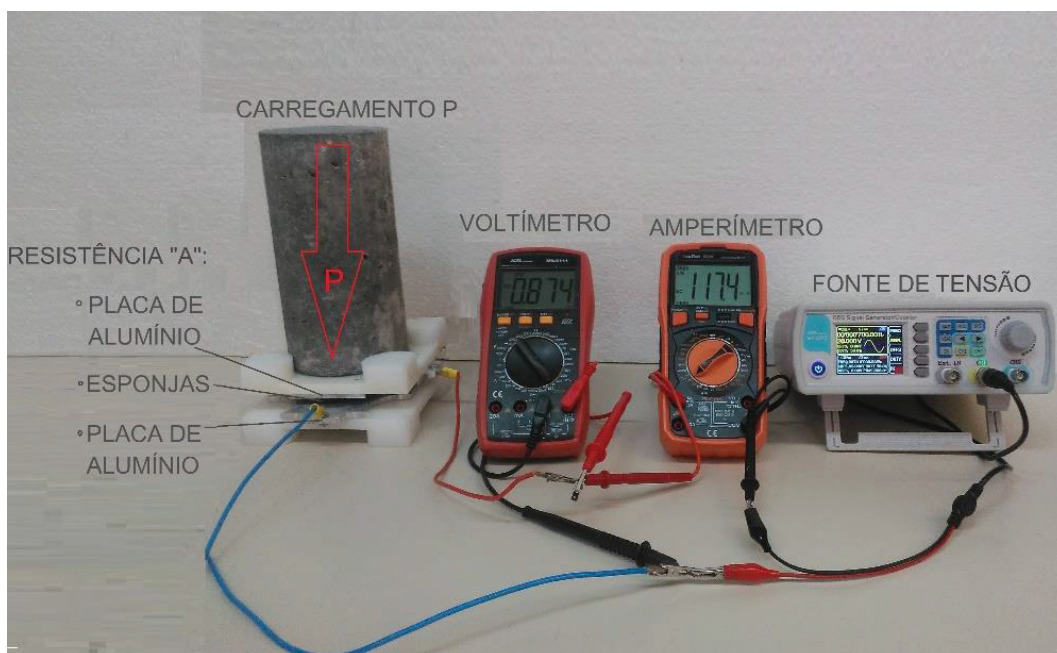
FIGURA 44 – MÉTODO DIRETO: a) MEDIÇÃO DA RESISTÊNCIA DOS ELETRODOS; b) MEDIÇÃO DA RESISTÊNCIA DO CONJUNTO CORPO DE PROVA MAIS ELETRODOS
