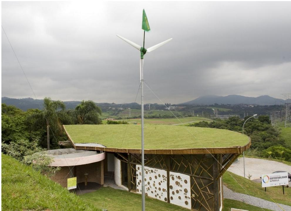
Fig. 3.2.4 – As técnicas de teto verde, captação de energia eólica e materiais naturais ficam evidenciadas no resultado estético do projeto
