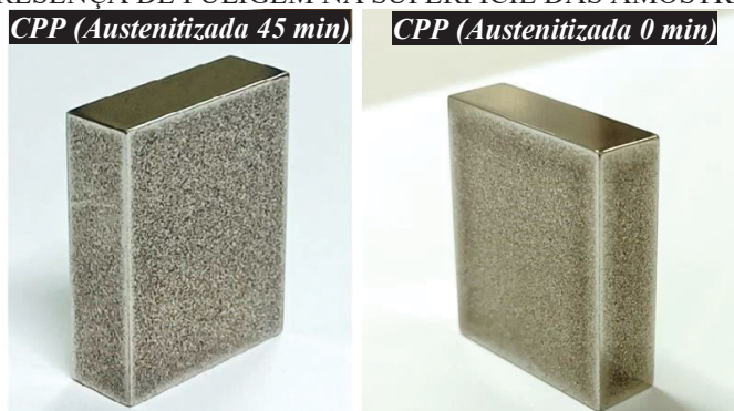
FIGURA 65 – PRESENÇA DE FULIGEM NA SUPERFÍCIE DAS AMOSTRAS DA SÉRIE III.
