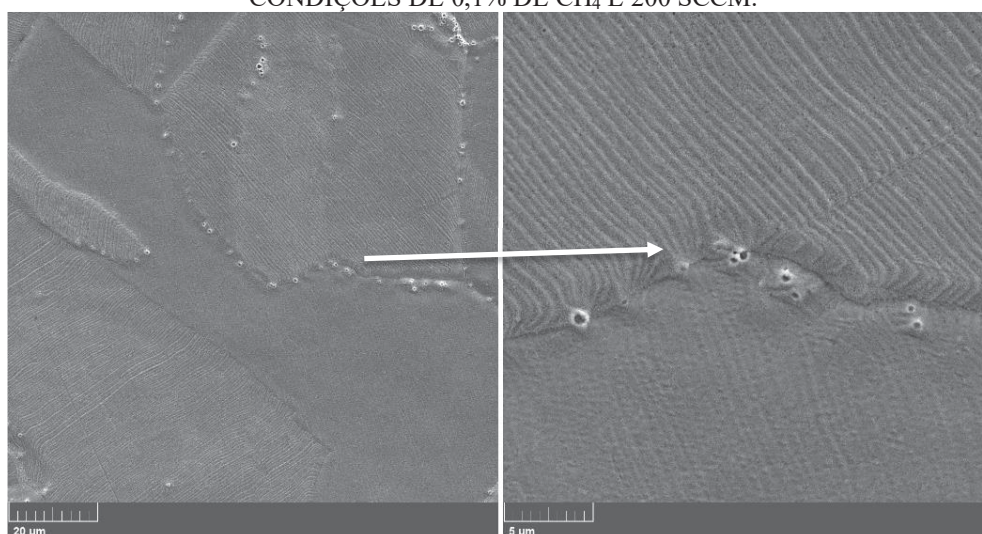
FIGURA 40 – MICROGRAFIAS OBTIDAS POR MEV DA FORMAÇÃO DE CAVIDADES NOS CONTORNOS DE GRÃO DA AUSTENITA EXPANDIDA PARA A AMOSTRA TRATADA NAS CONDIÇÕES DE 0,1% DE CH 4 E 200 SCCM.
