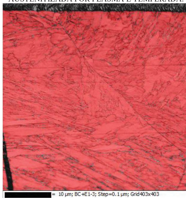
FIGURA 81 – MAPEAMENTO POR EBSD PARA IDENTIFICAÇÃO DE FASES PARA A AMOSTRA AUSTENITIZADA POR PLASMA E TEMPERADA.
