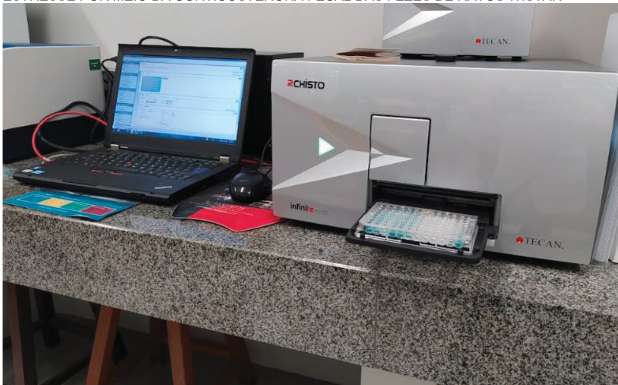
FIGURA 1 - LEITOR DE PLACAS DE ABSORBÂNCIA UTILIZADO PARA AVALIAR O NÍVEL DE ESTRESSE POR MEIO DA CORTICOSTERONA FECAL DAS FEZES DE RATOS WISTAR
