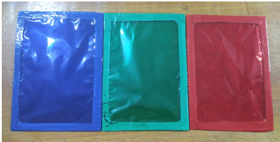
FIGURA 20 – Filtros feito de papel celofane para observar a mistura do sistema RGB.
