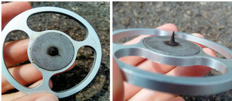
FIGURA 12- DISCO DE SEPARAÇÃO DAS PARTÍCULAS TOTAIS DO MP2.5, COM GRANDE QUANTIDADE DE PARTÍCULAS RETIDAS
