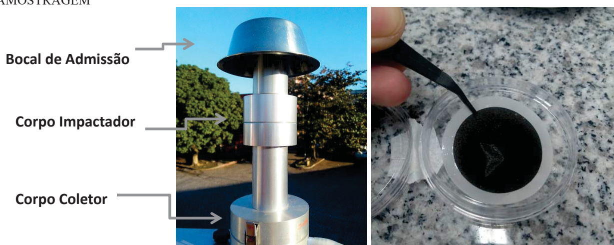
FIGURA 10- IMPACTADOR INERCIAL DO TIPO HARVARD E FILTRO DE POLICARBONATO APÓS AMOSTRAGEM
