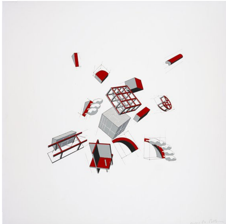
FIGURA 4.22: A construção das Folies a partir do cubo, adicionando-se diferentes elementos. FONTE: Villette, 2011.
