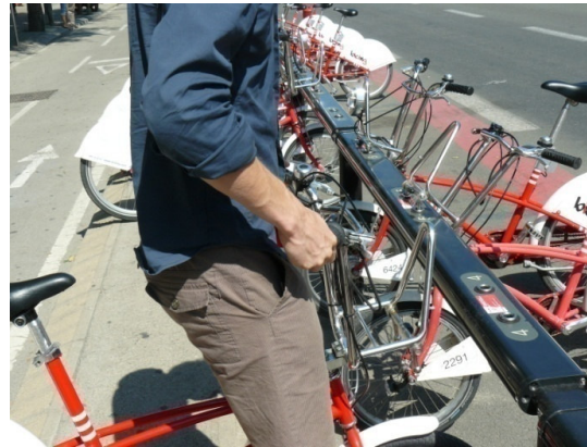
Figura 7: O empréstimo e devolução da bicicleta é realizado através do travamento da mesma à estrutura da estação. Fonte: Site do Bicing, 2009.
