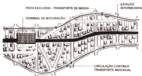
Fig. XX Desenho esquemático de como é constituído o Sistema Trinário de circulação, que compõe as vias estruturais da cidade de Curitiba;
