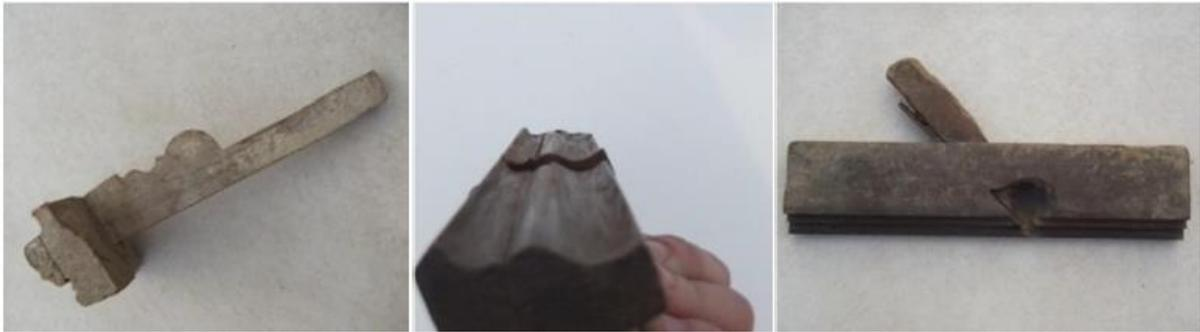
FIGURA 99 – FERRAMENTAS UTILIZADAS PARA MOLDAR DETALHES DE JANELAS E PORTAS POR ALEKSANDER MAJCZAK, RESPECTIVAMENTE: FERRAMENTA DE MOLDES, PLANA CURVA E PAINA DENTADA
