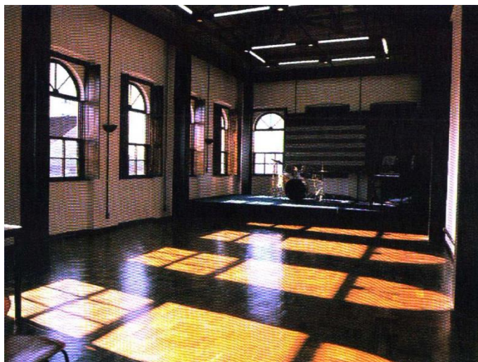
Figura 5 – Auditório. Localizado no último pavimento, consiste em uma sala ampla com palco elevado, sem qualquer tratamento acústico especial. O espaço é também usado para ensaios e atividades com grupos maiores, considerando as pequenas dimensões das salas de aula comuns. Além dos pilares, observa-se as treliças metálicas que sustentam o telhado, recomposto com telhas cerâmicas conforme volume original. Fonte: Design & Interiores.
