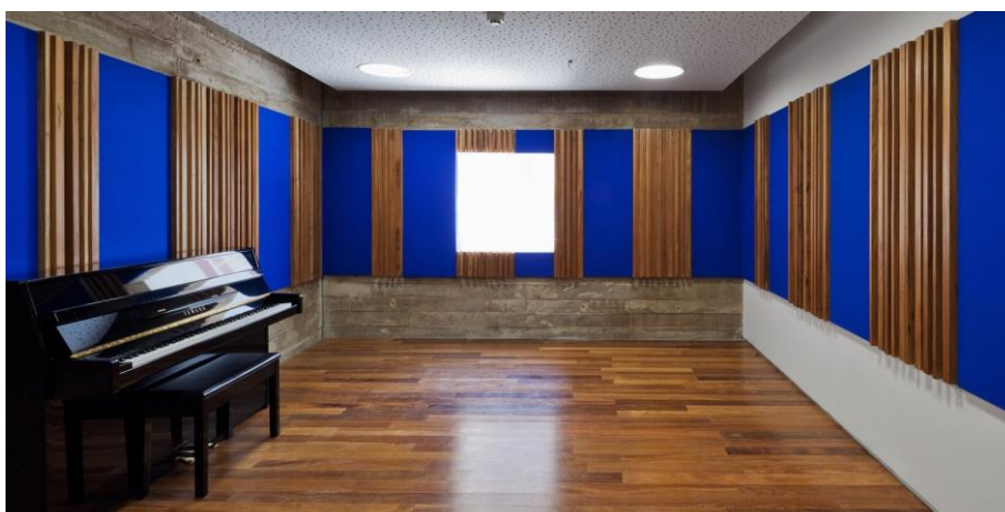
Figura 16 - Sala de música. Observa-se a opção por piso e revestimentos de parede em madeira, bem como de forro mineral perfurado para adequação acústica do espaço. Fonte: Archdaily
