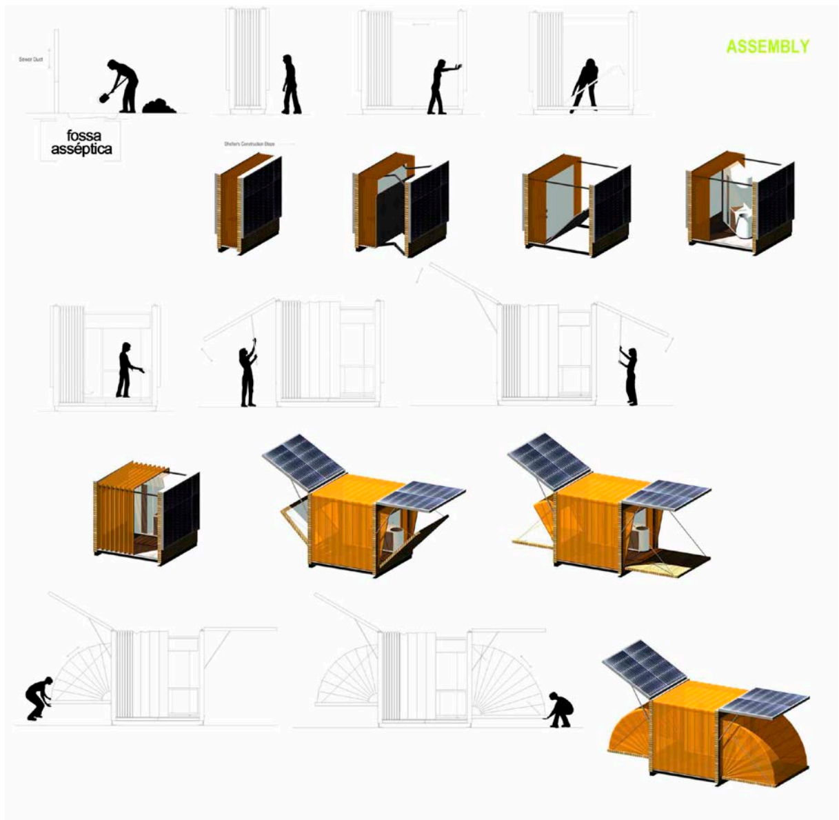
Figura 44 – Montagem dos módulos do projeto Shelter Box . (SEQUEIRA, 2008)
