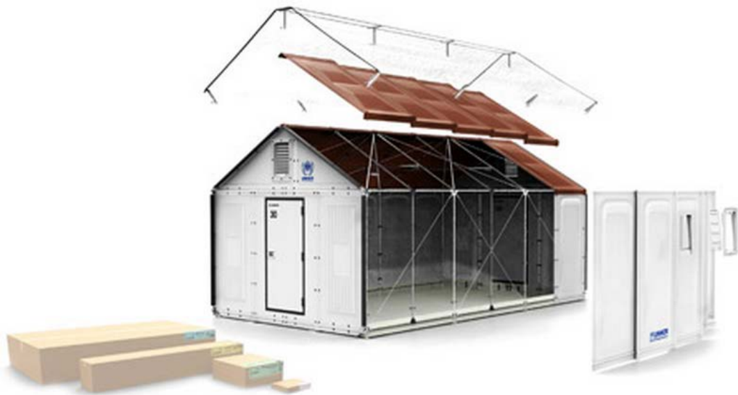
Figura 56 – Esquema de montagem do Better Shelter . (DEZEEN, 2013)
