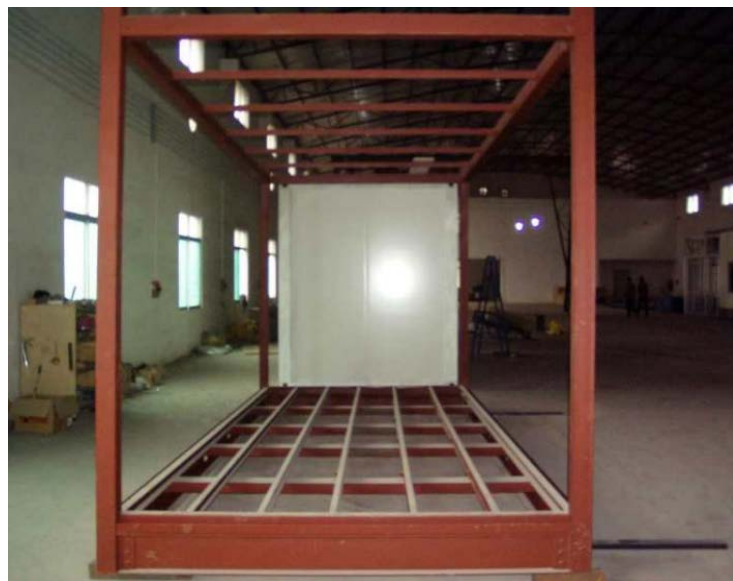
Figura 34 – Estrutura de um contêiner. (ALIBABA, 2015b)
