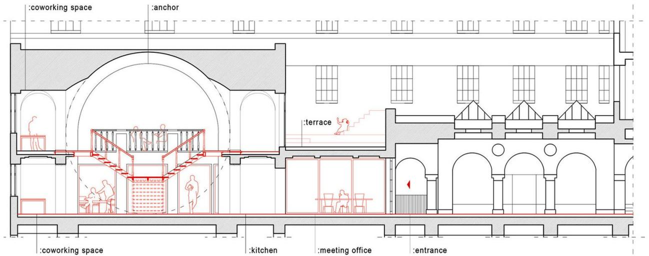
FIGURA 16 – HUB BELGRADO - Corte longitudinal. Elementos novos representados em vermelho.
