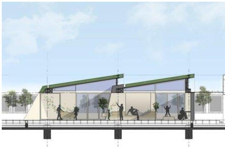
**Figura 3.1.7** – Seção longitudinal parcial *SK Yee Healthy Life Center* (Hong Kong, China): Aberturas em paredes opostas permitem ventilação cruzada e superiores geram a saída do ar quente por convecção.
